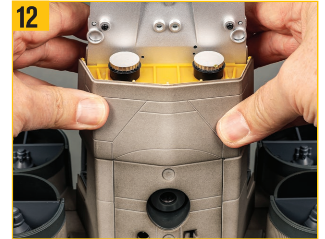
12 パネルをしっかり押し込み、ぴったりと取り付ける。
