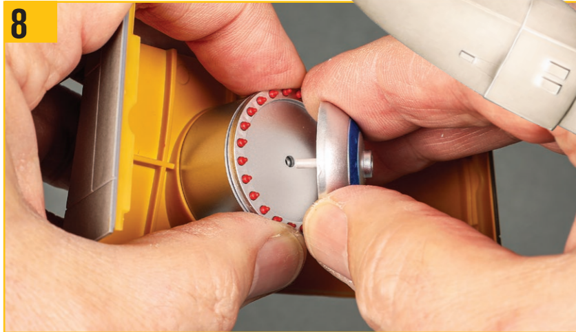
8 次に、加速度補正機ドラムから突き出ているピンを中央の穴に合わせる。
