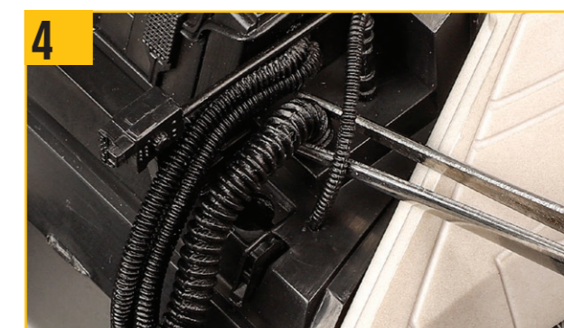
4 ホースCの上端を写真の穴に取り付ける。
