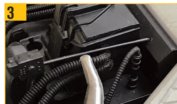
3 ホースBの上端を隣の穴に取り付ける。
