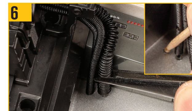
6 ホースA、B、Cの下端を手順5で示した3つの穴にはめ込む。楊枝で瞬間接着剤を一滴垂らすと(写真を参照)、しっかりと固定できる。
