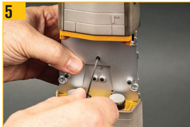
5 さらにXW02ネジを追加して、シートの前面を固定する。
