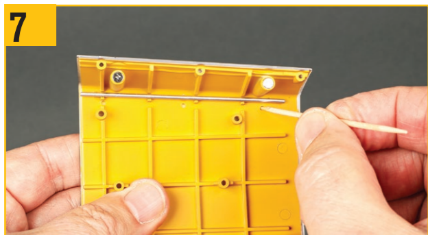
7 同様に少量の瞬間接着剤を使用して、左舷ガイドレール2を左舷ガイドレール1と平行に取り付ける。
