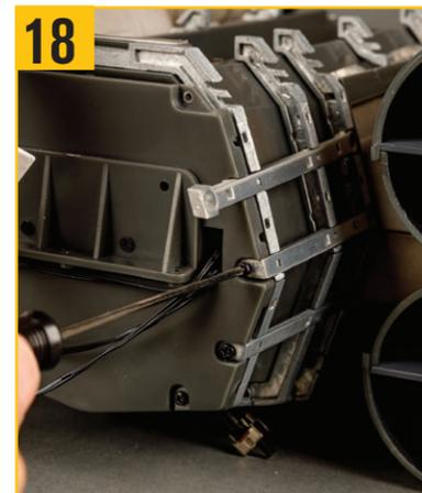
XW08ネジを使用して、左下中央後部胴体支柱の端を後部胴体パーツに固定する。
