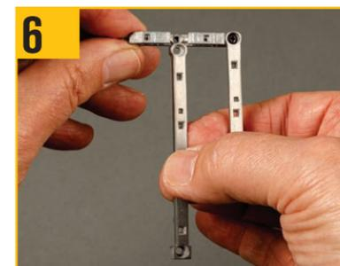
左上中央後部胴体支柱の丸い端を左胴体フレームAの写真の穴に合わせる。向きを間違えないように注意する。
