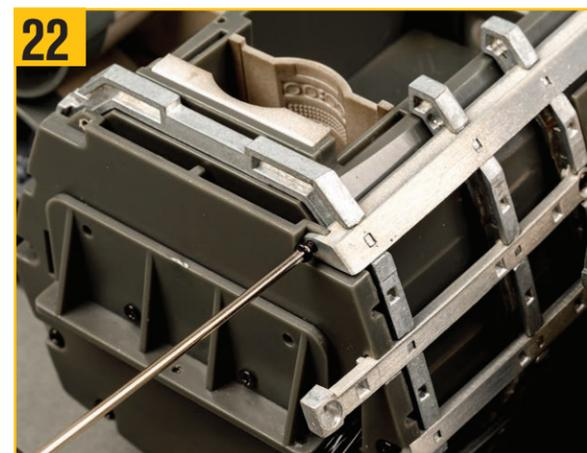
XW08ネジを使用して、支柱の前部を胴体パーツに固定する。
