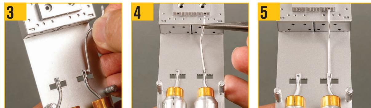
端の直角に付いているピンをマウントに取り付けられた右側のパイプの穴に取り付ける。
