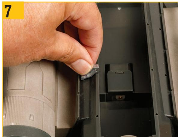
7 「R」の刻印がある2つ目の右後部胴体上部フレームを用意し、写真のように2つの穴に押し込む。
