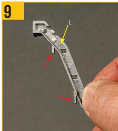
次に、ステージ80から左胴体フレームBを用意する。このフレームには、写真の位置に2本のピンがあり(手順12の左胴体フレームCと比較)、矢印の位置にL(「左」を表す)の刻印がある。
