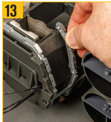
アストロメックソケットの背面に沿って後部胴体の左側に左胴体フレームCを合わせる。
