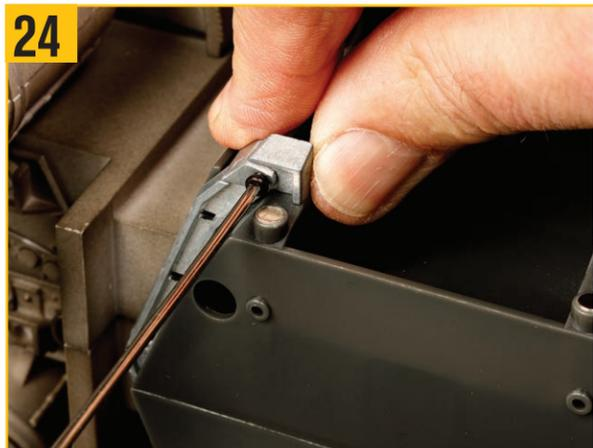
24 XW01ネジを使用して、支柱のもう一方の端を最後部のフレームに固定する。
