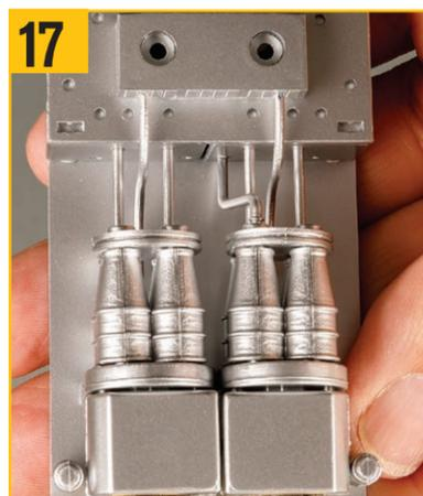
17 そして、直角になっている方の端をジェットパーツの内側の上部の穴に取り付ける。
