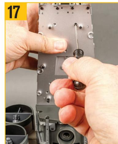
4本のXW08ネジを使用して、コックピットをフレームワークに固定する。
