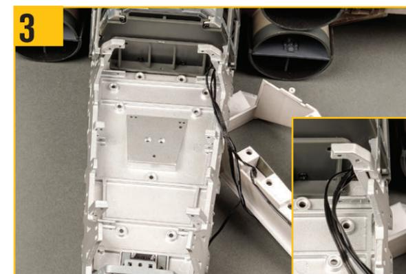
3 フレームがケーブルを挟まないようにして(挿入図)、胴体の前部を後部に合わせる。
