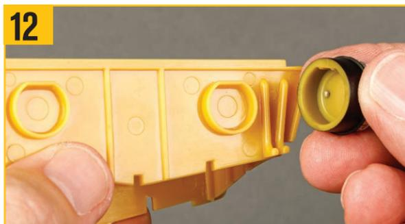
12 魚雷シーケンスサーボの内側は、魚雷ベイハウジングフロントの取り付け部と一致する平らな部分がある。
