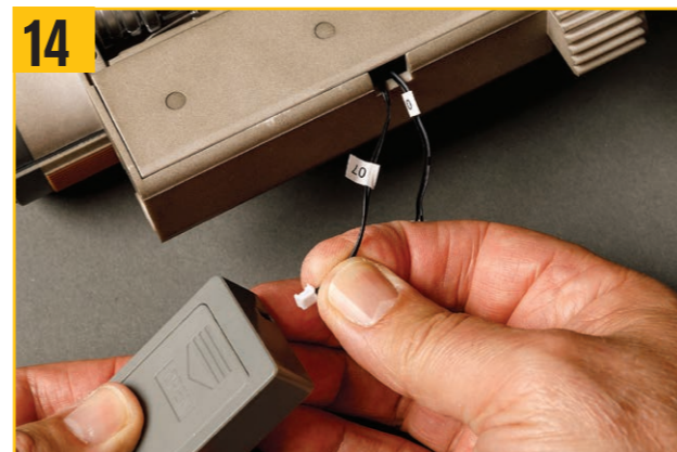
14 レーザーキャノンの配線が機能していることを確認するために、テストに使用したバッテリーボックスを用意し、翼のもう一方の端にあるプラグを接続して確認する。(エンジンライト用の2番目のプラグがあることに注意する。)
