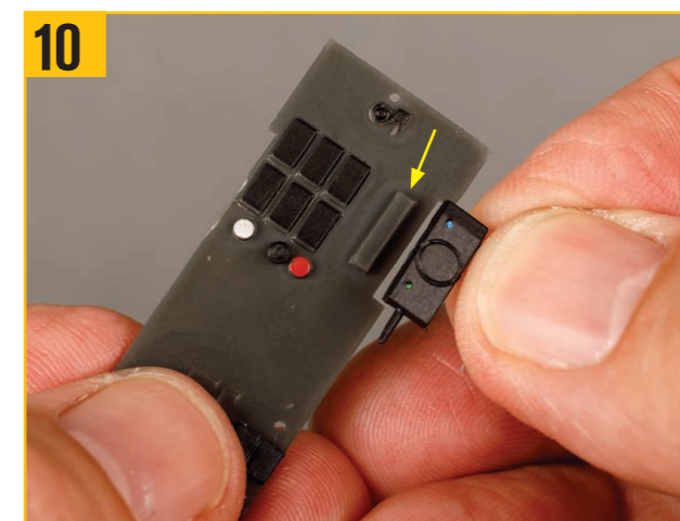
10 パーツAの背面にあるくぼみをパネルの写真の長方形のブロックに押し込むと、375ページの上部の画像のようになる。
