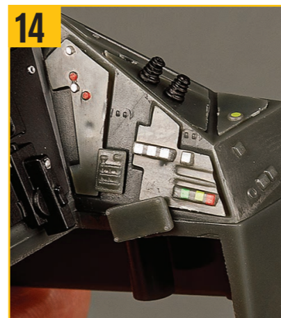
14 コンソールの右舷側は写真のようになる。写真に示すように、ディテールパーツ(G)はわずかな角度がついていることに注意する。
