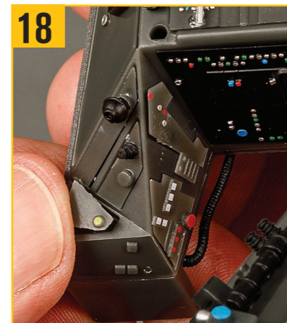
18 三角形のディテールパーツ(J)を写真のくぼみに押し込み、その位置決めピンを穴に合わせる。
