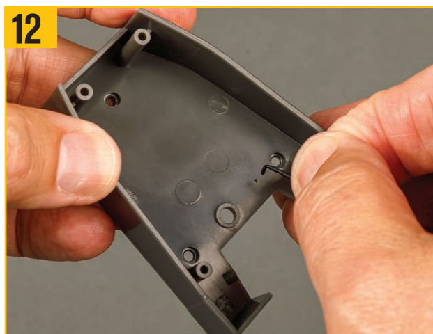
12 残りのリンクは、ステージ5で提供された前方コンソールベースの下側に収まる。
