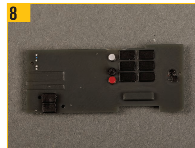
8 写真のようになるように、パーツBを完全に押し込む。
