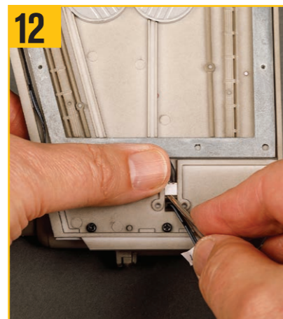
12 ステップ11のワイヤーの端プラグを、翼の穴の横にあるソケットに差し込む。
