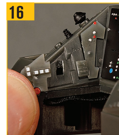
16 ディテールパーツ(I)を対応するくぼみに合わせ、位置決めタブをスロットに完全に押し込む。
