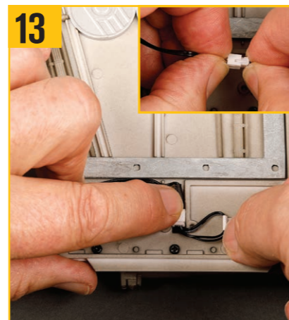
13 プラグとソケットを翼の所定の位置に押し込み、余った配線をきれいに巻く。
