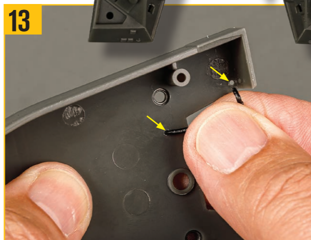
13 両端のピンを写真の穴に押し込む。
