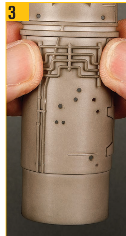
パーツAを写真の位置に押し込み、小さなピンが対応する穴に入ることを確認して取り付ける。
