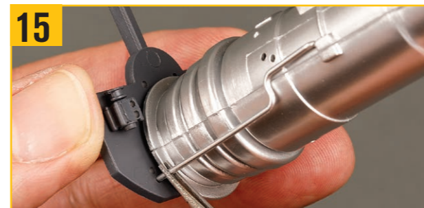
15 配管Aのもう一方の端を内部隔壁の写真の穴に取り付ける。ピンセットを使うと作業しやすい。
