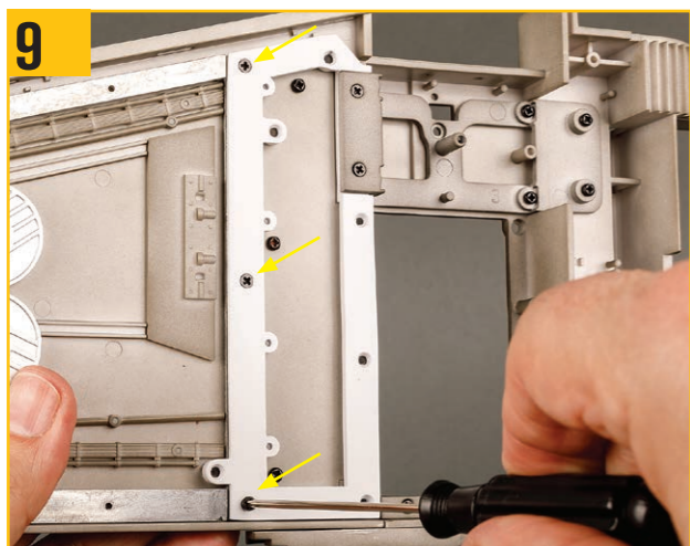
9 その後、矢印の穴をXW04ネジでねじ止める。
