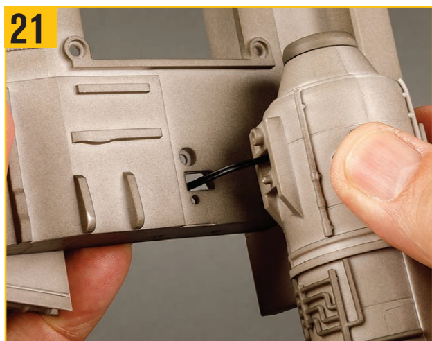
21 ケーブルを穴に通して、エンジンの取り付け穴と位置決めピンを合わせる。
