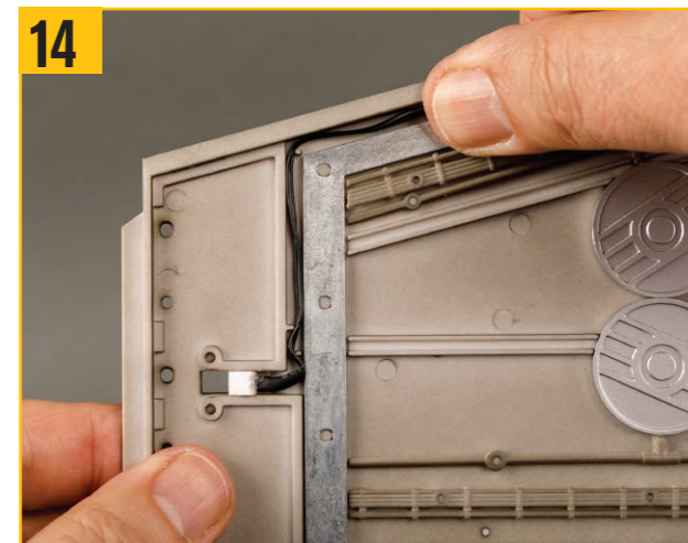
14 リード線を翼の外縁の周りに配線する。
