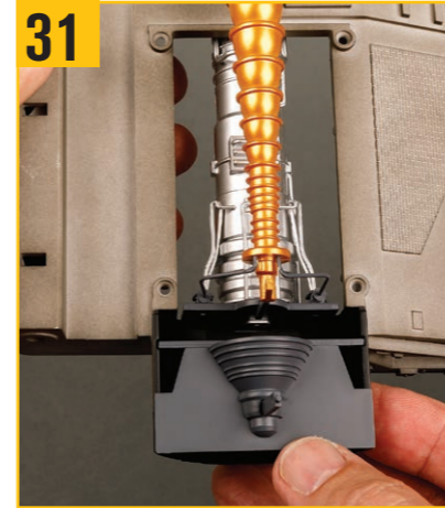
ステージ54で作成した gyrocopter の部品を、エンジンマウントの湾曲部分のスロットに取り付ける。
