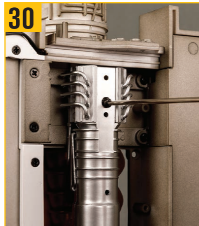
XW01ネジでパワー入力ユニットの端をエンジンマウントに固定する。
