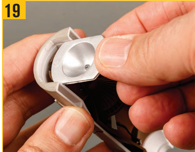
19 そしてリフレクターをしっかりと押し込む。
