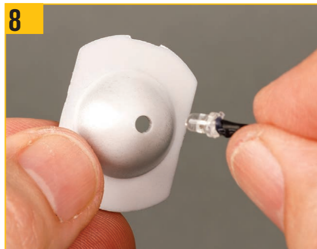
LEDの先端をリフレクターの穴に取り付ける。
