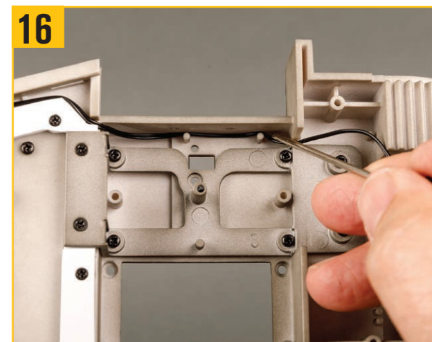
16 必要に応じてドライバーの先端を使用して、リード線を翼の支柱の後ろに配線する。
