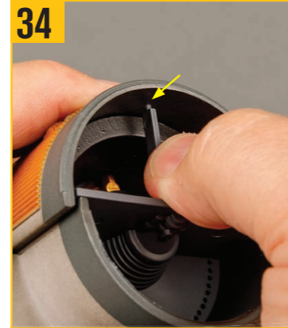
ケーシングの前面を平らにするために、冷却羽根の端にあるピンを写真の指定の穴に取り付ける必要がある。
