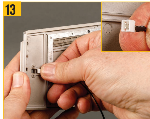
13 ソケットの端を確認し、ソケットをウイングチップ近くのくぼみにしっかりと取り付ける。
