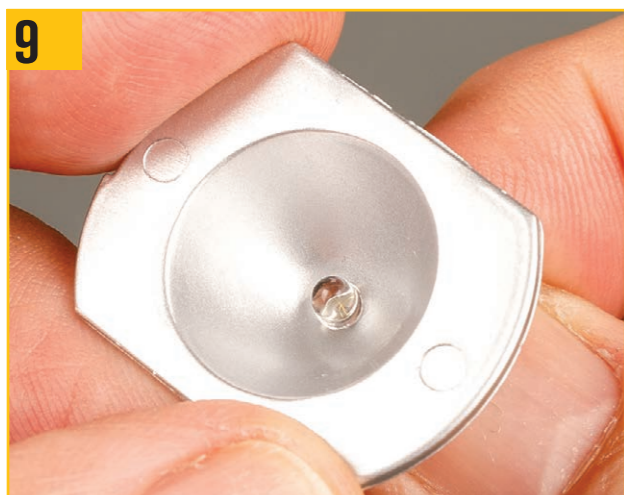
LEDの先端が反対側に出るようにする。
