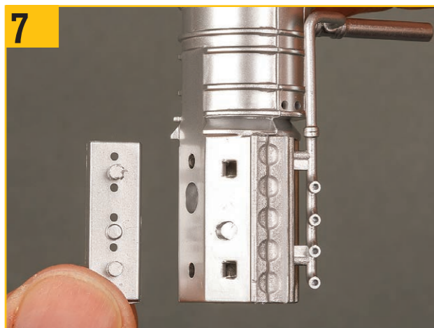
7 背面に3つのラグがあるプレートを用意し、パワー入力ユニットの下半分にある写真の3つの穴に合わせる。
