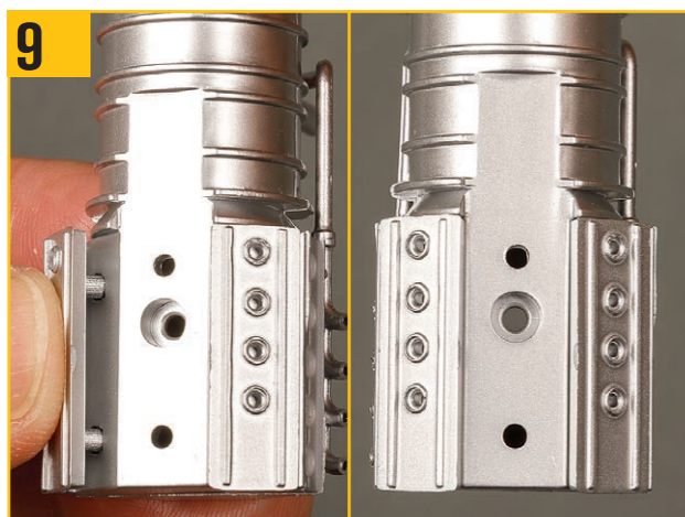
9 手順7と8を繰り返し、2つ目のプレートを合わせる。このプレートの背面には2つのラグしかない。
