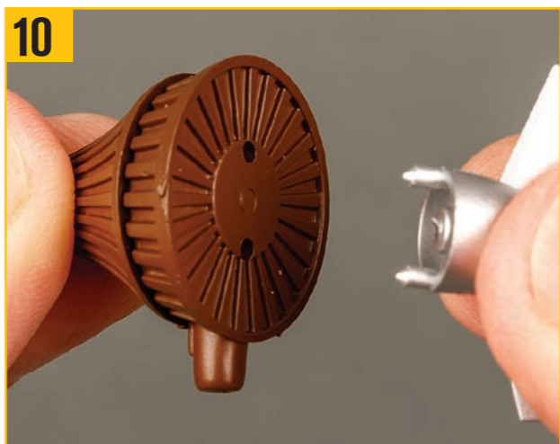
ターボインペラーの2本のピンをターボ発電機本体の対応する穴に合わせる。
