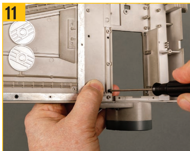
XW02ネジでパーツを固定する。
