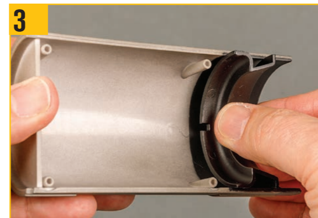
ノズルをピンに取り付ける。
