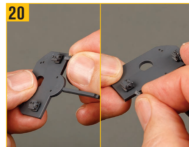
20 端にD字型の突起がある2つの小さなディテールパーツを用意する。ステップ19で取り付けられたパーツの対応する穴に突起を合わせ、パーツを所定の位置にしっかりと押し込む。
