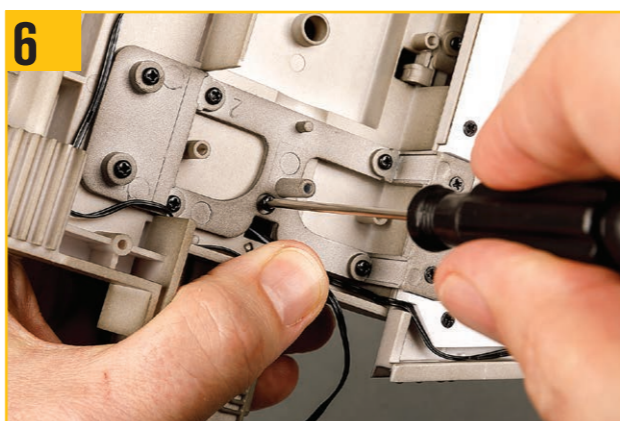
6 XW02ネジで写真の穴をねじ止めて、エンジンを所定の位置に固定する。
