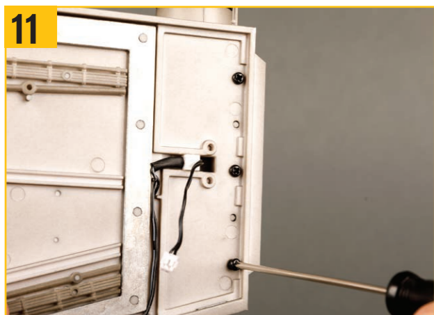
11 残りの2つの穴もXW02ネジでねじ止める。
