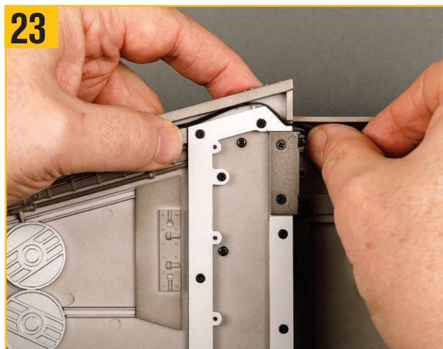
エンジンマウントに到達するまで、経路に沿ってケーブルの配線を続ける。
