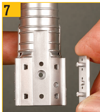
7 背面に3つの突起があるプレートを用意し、パワー入力ユニットの下半分にある写真の3つの穴に合わせる。
