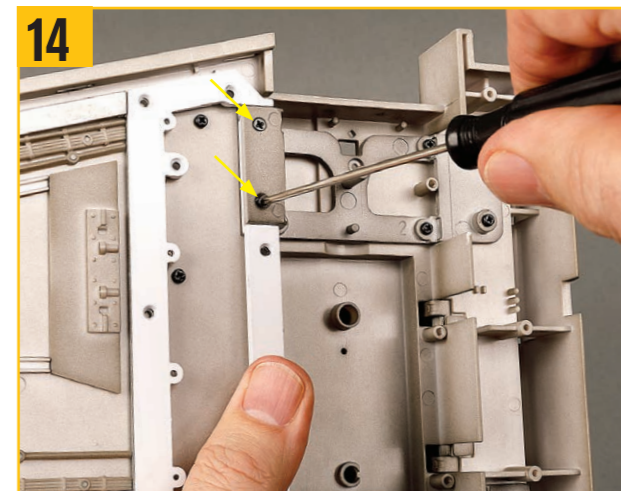
14 大きいエンジンマウントプレースとインナーウィングフレームが合わさった2つの穴にXW04ネジをねじ止める。
