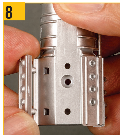
8 ステップ7を繰り返し、2つ目のプレートに合わせる。このプレートには、背面にラグが2つしかなく、写真のようになる。
