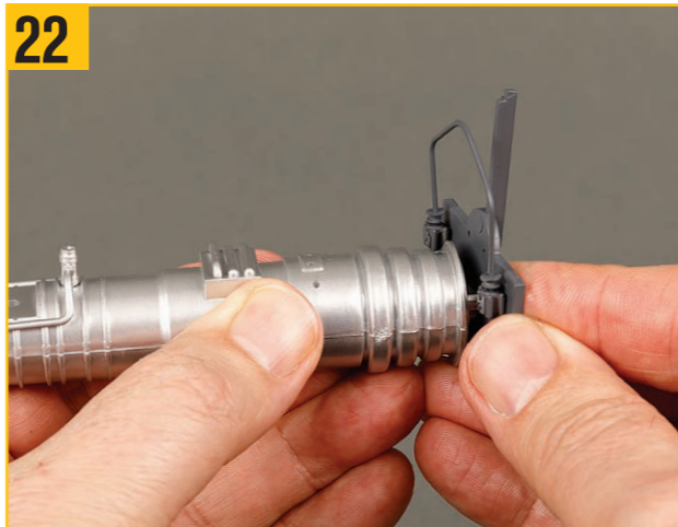
22 内部隔壁の大きなD形の穴をパワー入力ユニットの端にある対応するラグに合わせ、パーツを写真のようにしっかりと押し込む。
