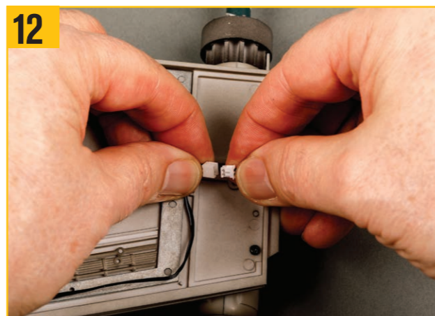
12 下翼の周りを沿わせたケーブルの端にあるソケットを取り、レーザーキャノン側のケーブルの端にあるプラグに差し込む。
