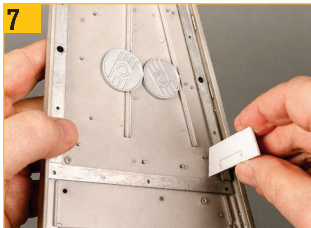
7 翼根留め具を用意し、背面の2つの穴を翼の対応するピンに合わせる。
