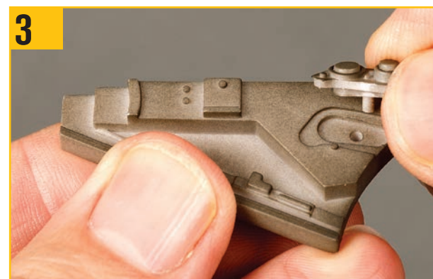
組み上げたディテールパーツを前縁サポートの写真で示した凹部に、平らになるように押し込む。
