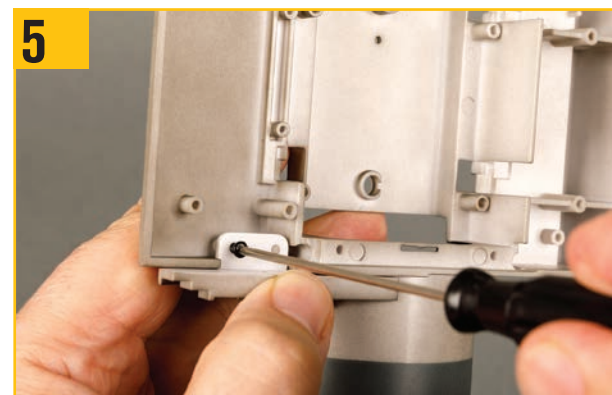
取り付け金具の左側の穴を位置決めピンに押し込み、もう一方の穴をXW02ネジで固定する。
