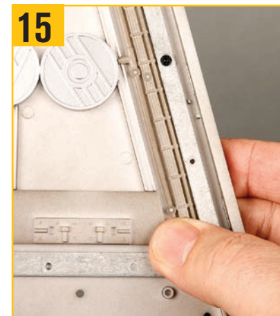
15 ピンに導管を押し込む。
