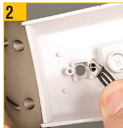
2 写真が示す片側に開口部があるくぼみの部分にアンテナを合わせる。
