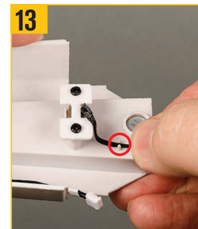
13 ワイヤーを写真のように配線し、2つのポストの間に押し付けて（円で示した部分）、所定の位置に固定する。
