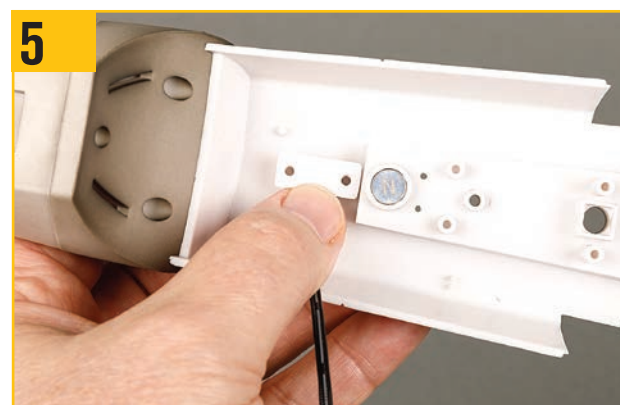
5 保持プレートの平面の方を上にして、所定の位置に押し込みむ。
