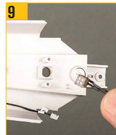
9 写真で示した円形の穴があるくぼみにアンテナを合わせる。ワイヤーは近くの磁石に面している必要がある。
