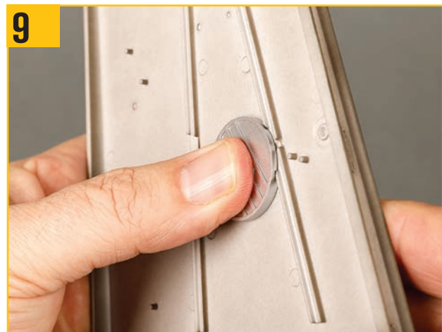
9 写真の位置で翼に取り付け、ラグを調整して、くぼみが翼の長いリブに合うようにする。
