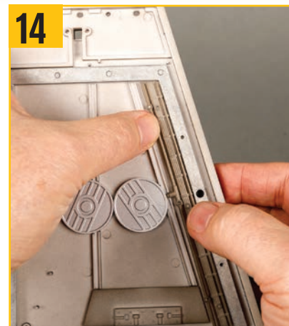
14 写真のように後縁の導管を並べ、パイプの3つの穴を翼の対応するピンに合わせる。
