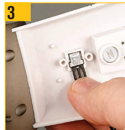
3 アンテナのケーシングをくぼみに押し込んで、ぴったりと収まり、ワイヤが開口部から出ていることを確認する。
