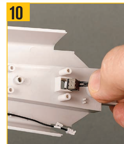
10 写真のように、スイッチボタンをくぼみに取り付ける。
