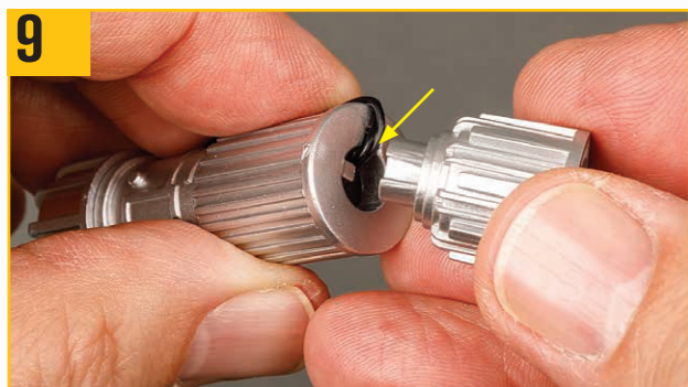
9 ワイヤーを写真の矢印の溝に通し、ユニオンの凸部に後部レーザージェネレーターエンドキャップの凹部を合わせる。
