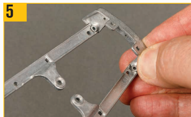
5 2つの丸い突起がサイドフレームの上向き端の内側に合うようにする。
