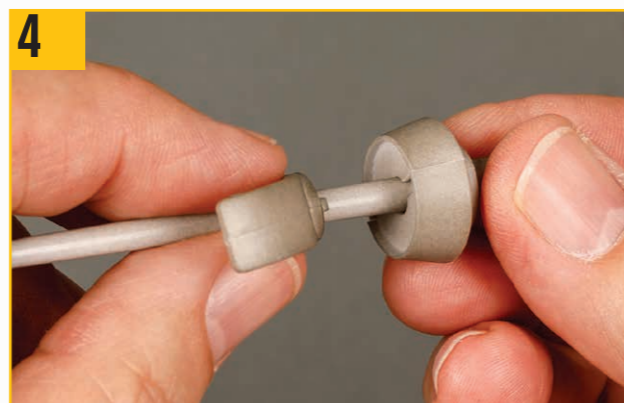
4 サブレッサーの穴にエミッタを通し、サブレッサーマウントの凹部にサブレッサーの凸部を合わせて押し込む。
