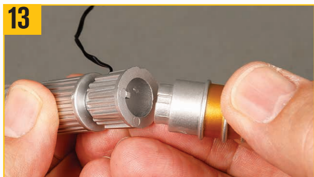
13 後部レーザージェネレーターの端の凹部をエンドキャップの凸部に合わせ、押し込む。
