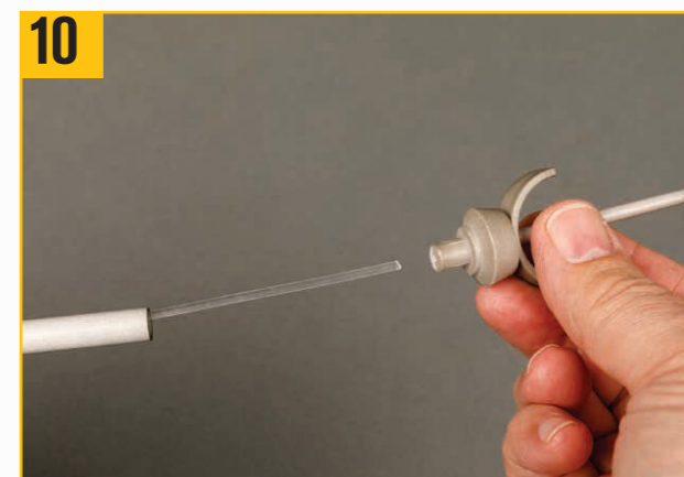
10 光ファイバーをレーザーキャノンエミッタに滑り込ませ、砲身に押し込む。
