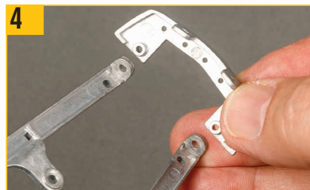
4 前方クロスメンバーは写真の位置に取り付ける。
