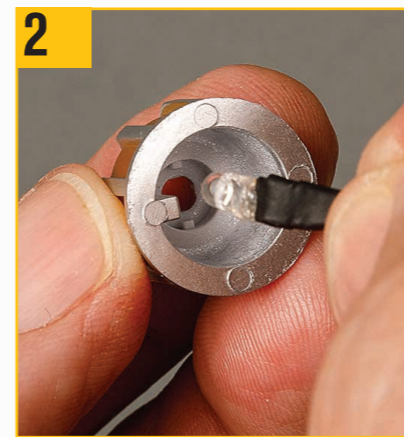
前方レーザージェネレーターエンドキャップの端にある小さな穴にLEDを取り付ける。
