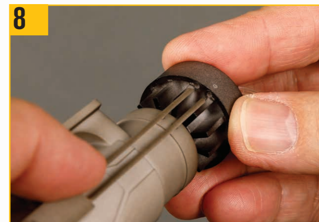
8 レーザージェネレーターの2つのサイドチューブがフロントエンドキャップの2つの穴に合うように押し込む。
