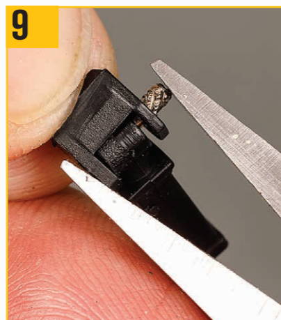
9 表面が滑らかなプライヤーを慎重に使用してピンを完全に押し込み、ストラットボディを固定する。
