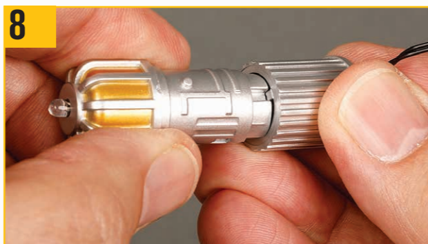
8 写真のようにユニオンをジェネレーター本体に押し込む。
