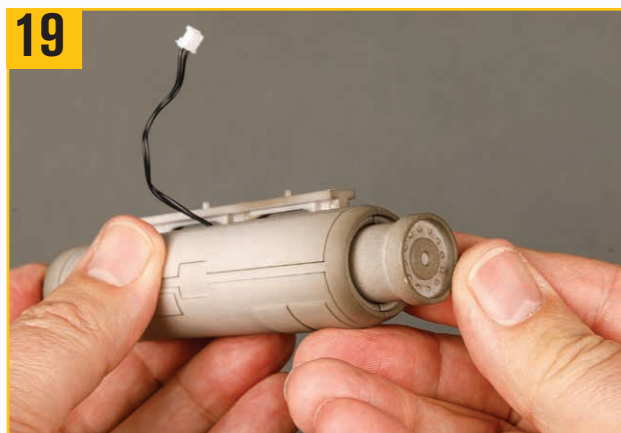
19 エンドキャップをしっかりと所定の位置に押し込む。これにより、ハウジングの2つのパーツが固定される。
