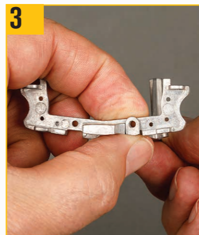
3 写真のように2つのパーツの固定穴を合わせる。
