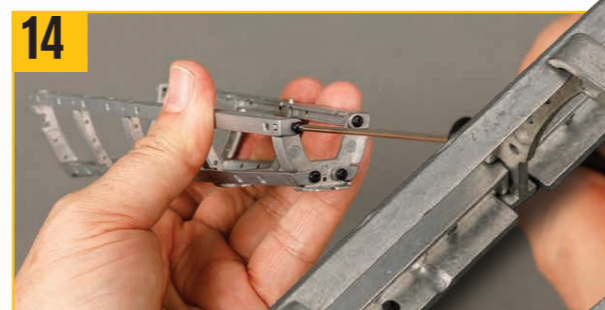
XW01ネジでストラットCとDの両端を固定する。
