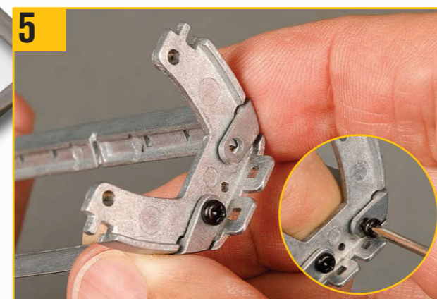
5 固定穴を揃え、パーツをXW01ネジで固定する。
