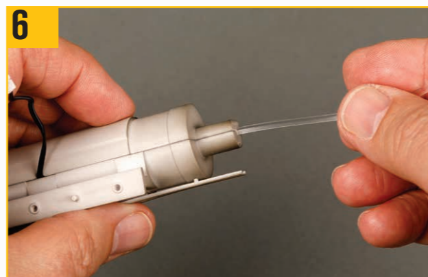
6 光ファイバーの先端をレーザージェネレーターの端にある穴に押し込む。
