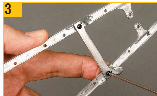
3 2本のXW01ネジでクロスメンバーを固定する。
