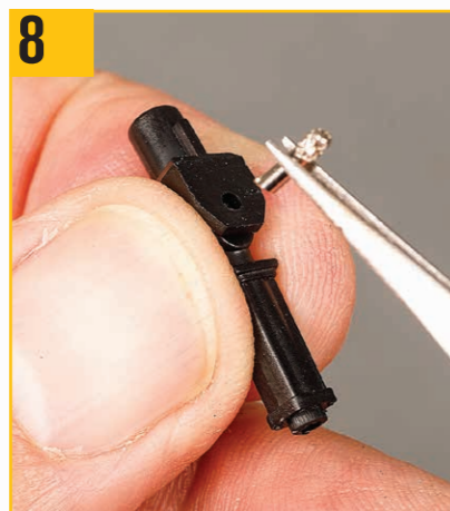
8 大きい方のピボットピンを1つを用意し、滑らかな端部の方をパーツの穴に挿入する。
