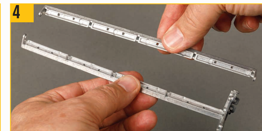
4 「R」のマークが付いた2番目のストラット(B)をクロスメンバーの反対側に取り付ける。
