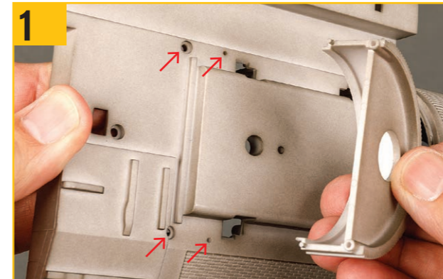
エンジンマウントと下部リアエンジンケーシングを写真のように持ち、矢印の穴と対応するピンを確認する。
