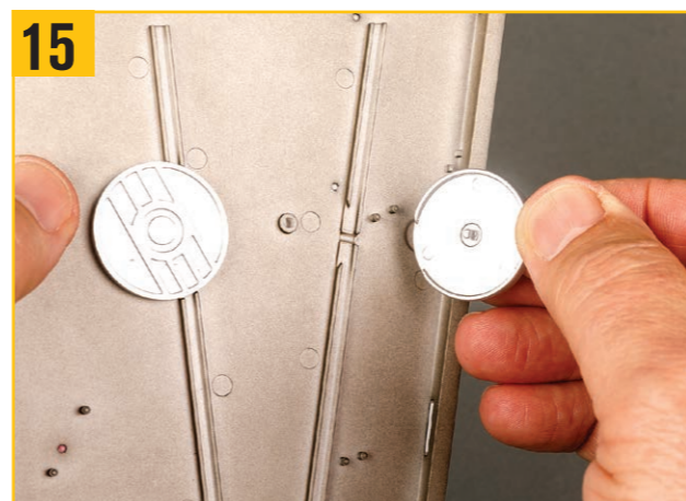
所定の位置にしっかりと押し込み、ディスクの裏側にある凹部と同じようにピンを揃える。
