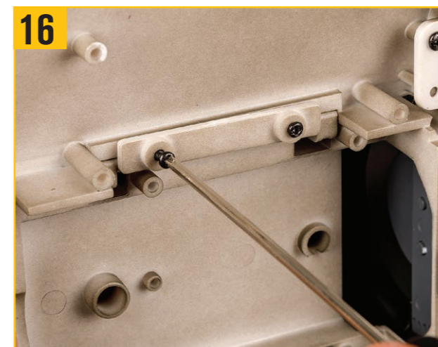
16 2本のXW06ネジでヒンジ固定具を固定する。
