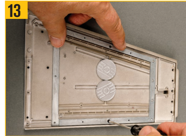
13 フレームを所定の位置に固定するために、XW03ネジで写真で示す穴をねじ止める。
