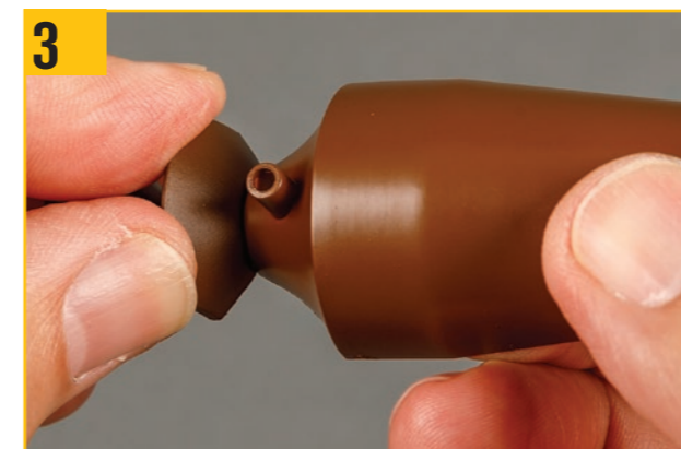
チャンバーマウントのピンをしっかりと押し込む。
