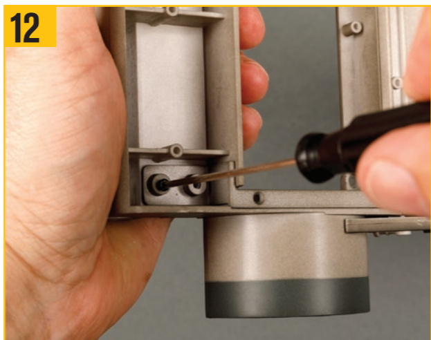
写真で示した穴をXW02ネジでねじ留めする。
