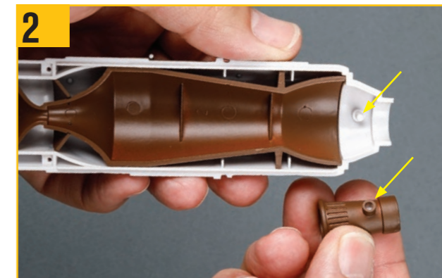
2 アルヴァイルダンパーには、エンジンケーシングから突き出ているピンと一致する取り付け穴がある。
