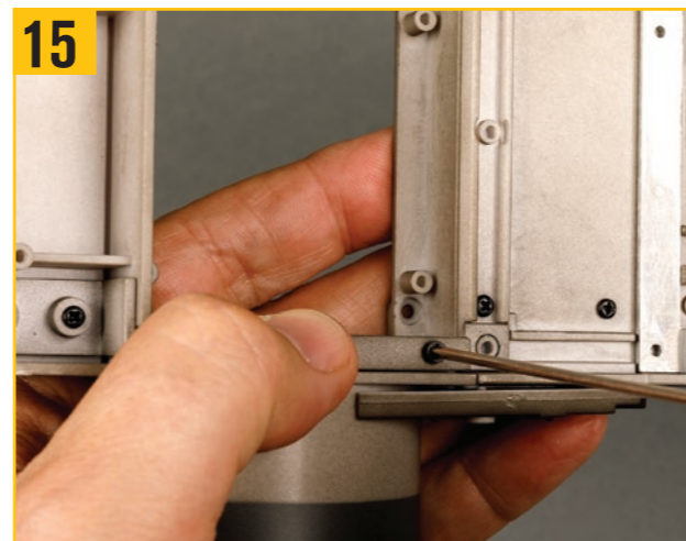
続いて右側の小さな穴をもう1本のXW03ネジでねじ留めする。
