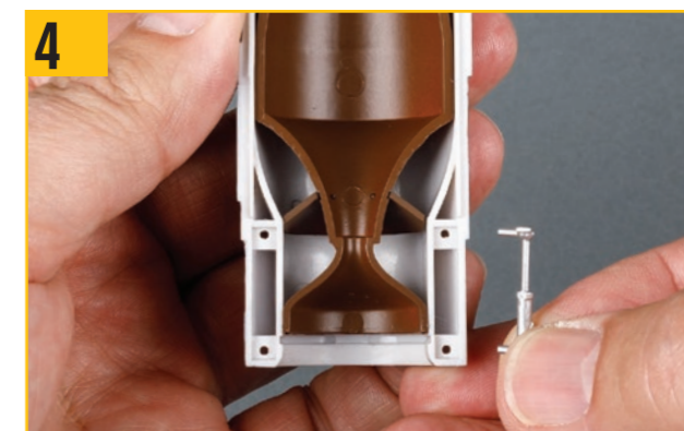
4 油圧アジャスターの2つのピンをエンジンケーシングの2つの穴に合わせる。写真のように油圧アジャスターが正しい方向になるように注意する。
