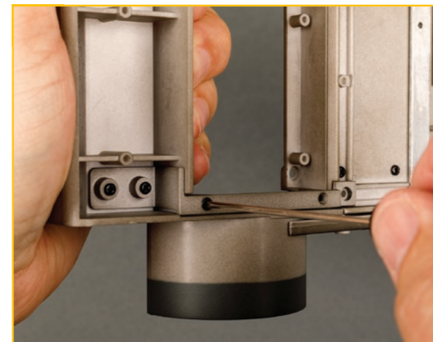
写真で示した小さな穴をXW03ネジでねじ留めする。
