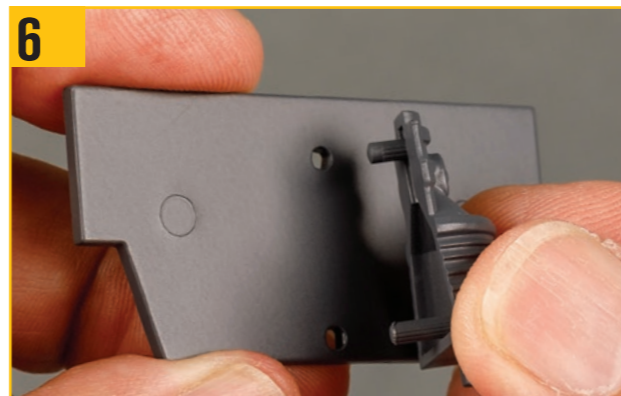
6 ジャイロコーン(下)のピンを水平翼の穴に取り付け、翼が正しい方向になるようにする。
