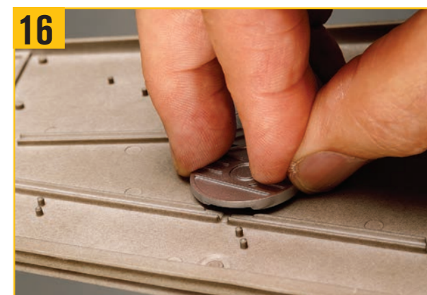
16 パワーカップリングBの切り欠きが、右舷上翼(上)にあるラインに合っていることを確認して、中心をしっかりと押し付けて取り付け。
