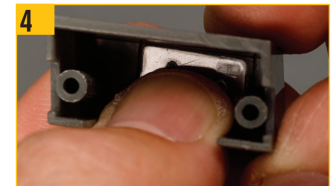
合わせたら、クリアパネル(右)を押し込んで、計器パネル(右)に取り付ける。
