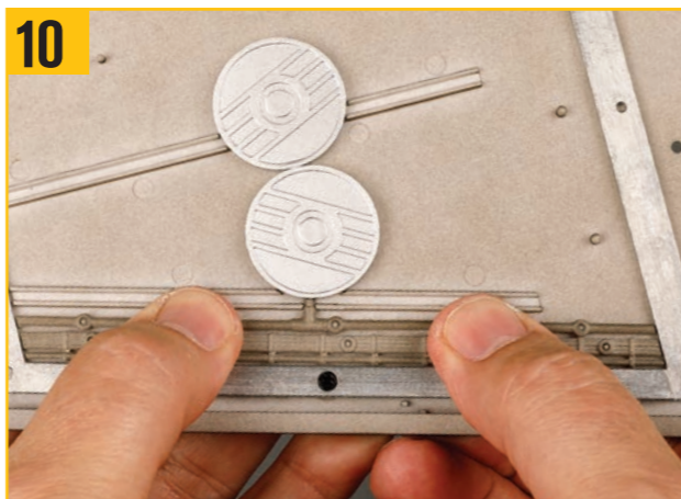
10 写真の位置に導管を合わせピンに押し込む。
