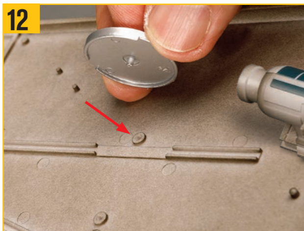
12 パワーカップリングAの真ん中にあるピンを、右舷上翼(上)にある穴(赤矢印)のDカットに合わせて取り付け。
