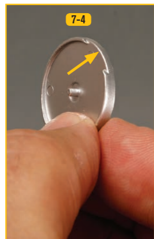
11 パワーカップリングの周りに2箇所の切り欠き(赤矢印)があるのがA、1箇所の切り欠き(黄矢印)があるのがBとなる。
