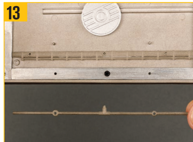
13 前縁の導管を写真のように保持し、導管の2つの穴を右舷上翼の対応するピンに合わせる。
