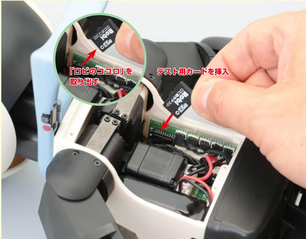
まずはバッテリーをしっかりと充電し、背中のカバーを開ける。「ロボのココロ」を取り出し、テスト用のmicroSDカードを差し込もう。
