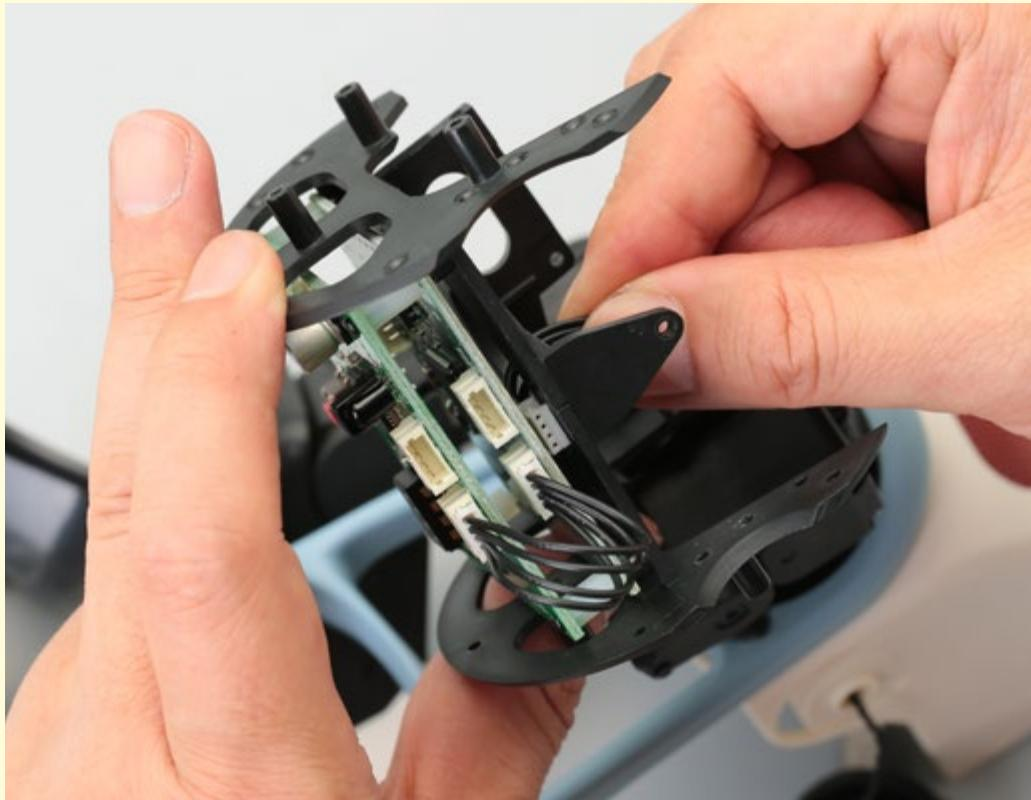
前ページで取り外したコネクターを基板とヘッドベースの間から抜きながら、ヘッドベース(基板や目、ヘッドカバーなどがつながったまま)を上半身から取り外す。もし、ケーブルのコネクターをうまく引き出せない場合は、リモコンボードを取り外して行おう。
