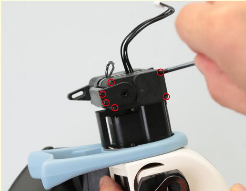
右側の首:縦回転サーボの長いネジ4本と、クラシクサーボホーンを留めている2本のネジを抜く。
