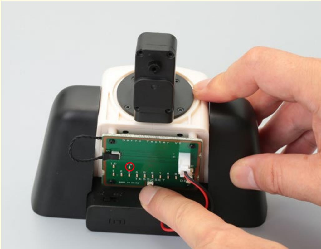
上腕サーボに接続されていたケーブルを取り外し、**テストボード**に付いているケーブルを使って動作テストをする。IDが「**20**」で動作するか確認しよう。
