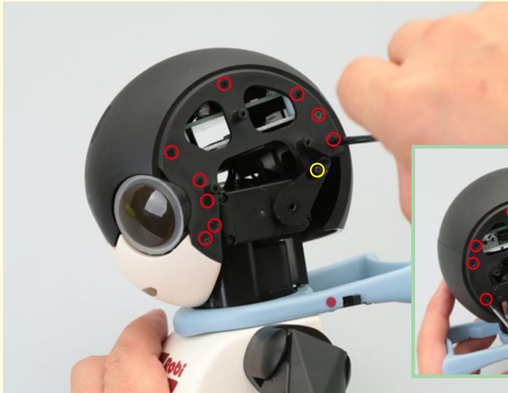
ヘッドカバー、目、フェイスカバーを留めている両側のネジ(計18本)と、スライダーサーボホーンの長いステップネジ(黄色の円)を抜く。
