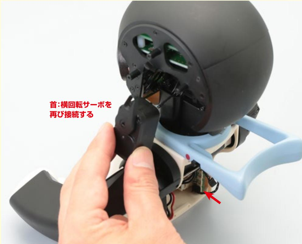
首: 旋回サーボからのケーブルに、首: 横回転サーボをつなぎ、もう一方のケーブルをマイコンボードのいちばん下に接続し、スイッチを入れよう。
