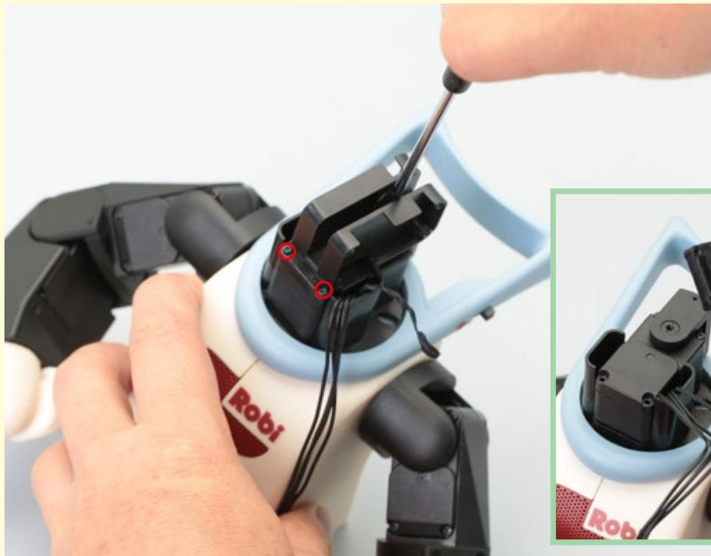
ネックサーボホルダーを留めている中央のネジと前方の長いネジを抜き、取り外す。
