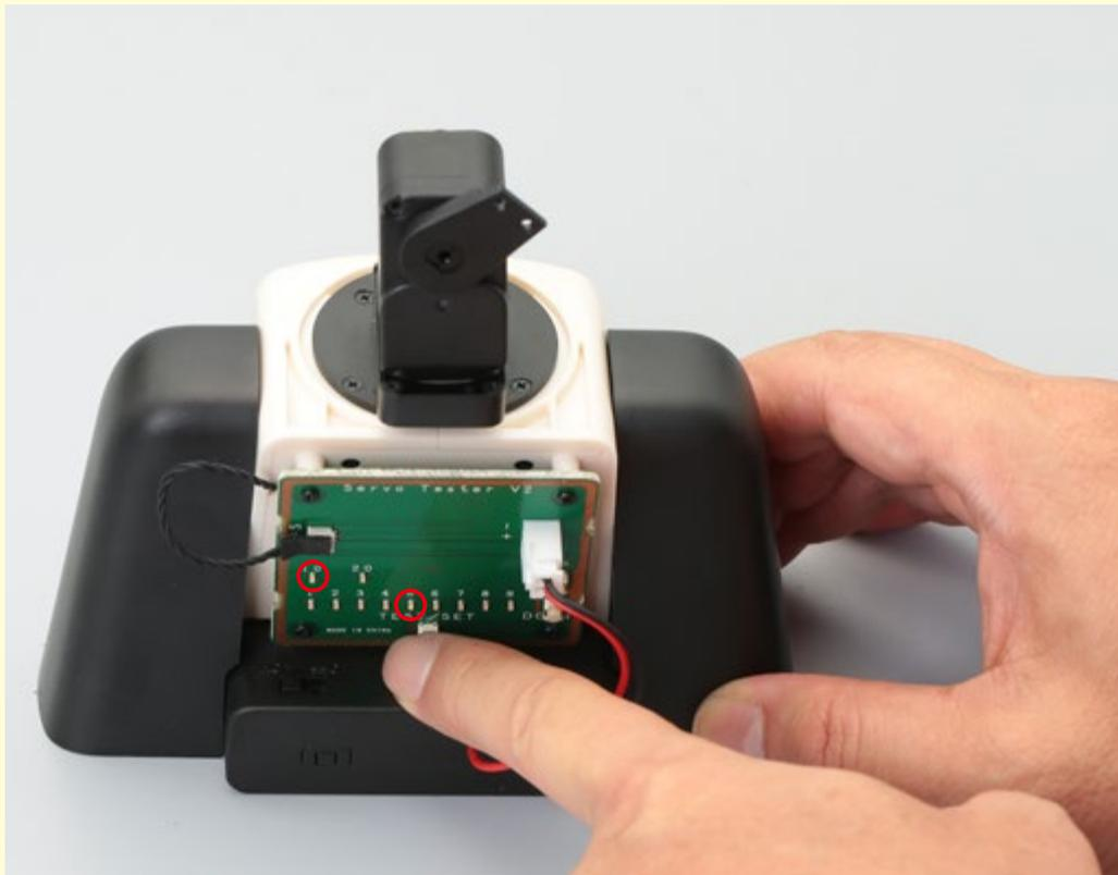
テストボードのケーブルを使い、首:縦回転サーボのテストをする。
