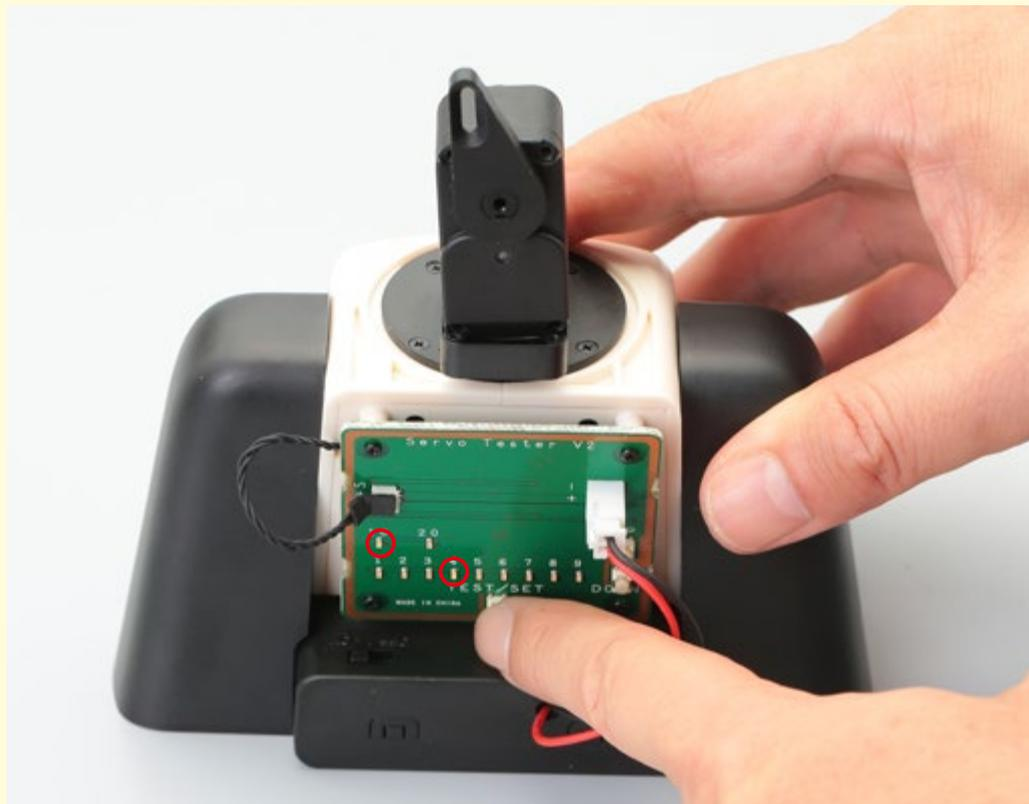
テストボードに付いているケーブルを使って、ID「14」で動作するかテストをする。
