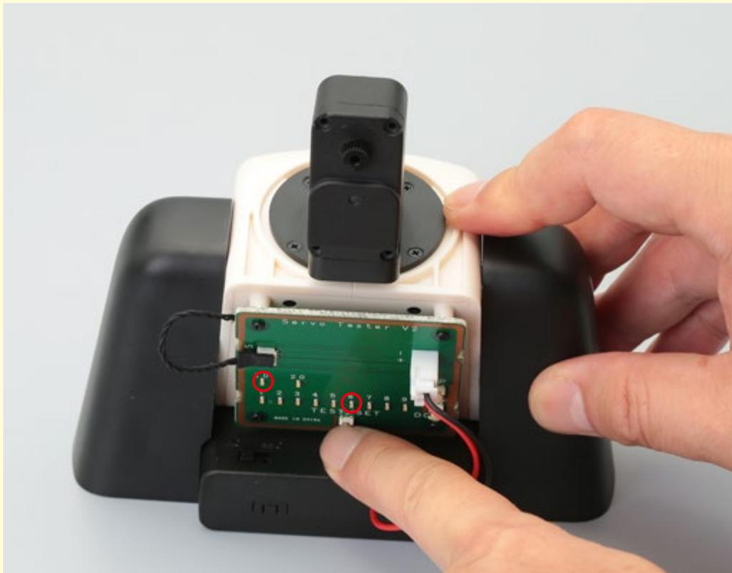
腰サーボに接続されていたケーブルを取り外し、**テストボードに付いているケーブル**を使って動作テストをする。
