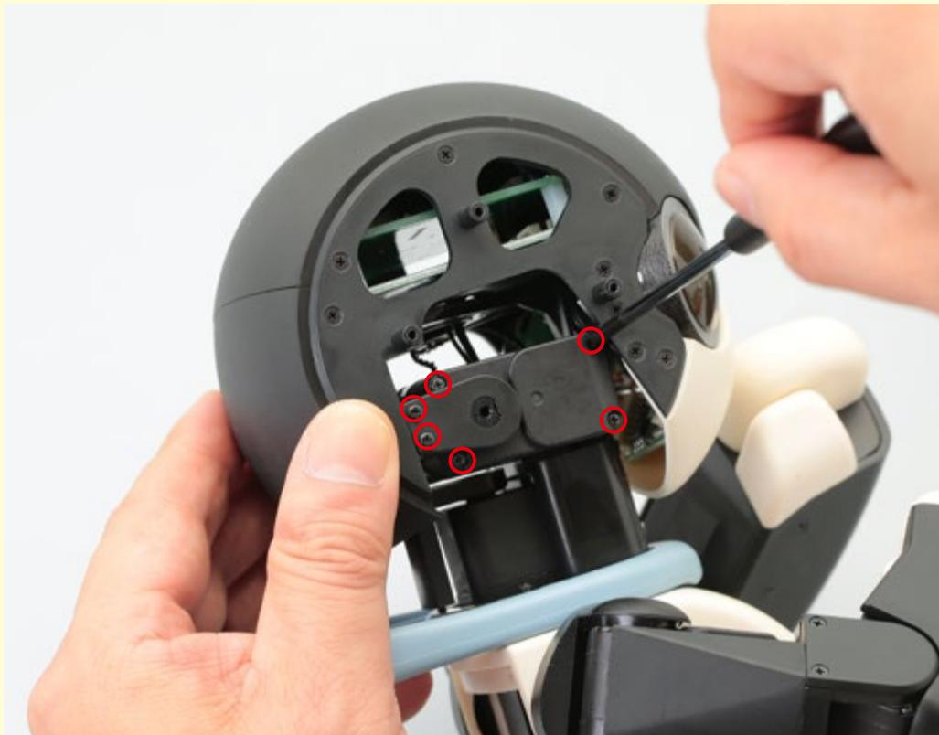
右側の首:縦回転サーボの長いネジ4本と、クランクサーボホーンを留めている2本のネジを抜く。
