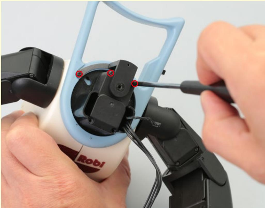
首: 旋回サーボを留めている2本のネジと、マフラーリンク金具を留めているネジを抜く。
