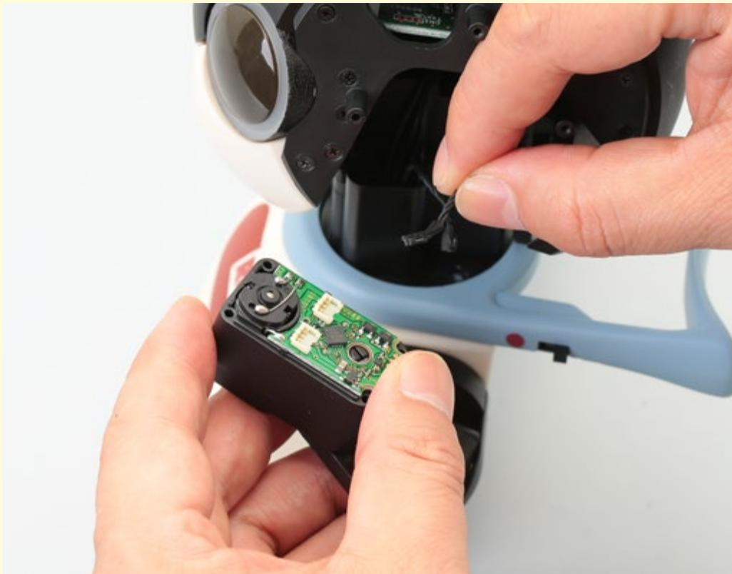
2本のサーボケーブルがきちんと接続されているかどうか確認し、両方のケーブルを抜き、首:横回転サーボを取り外す。
