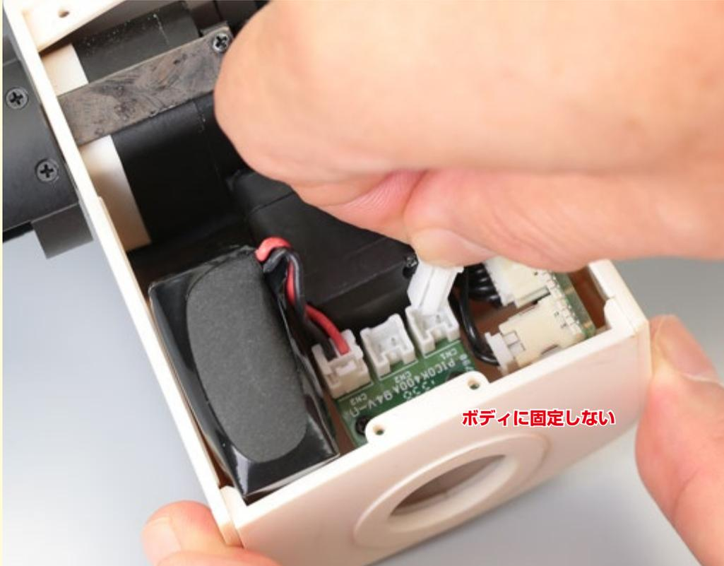
各サーボのテストでは、テストボードだけでなくマイコンボードを使う場合もある。そのときは分電盤にバッテリーのコネクタ、スイッチケーブルのコネクタを差して使用する。なお、ボトムボディカバーはボディに固定しない。
