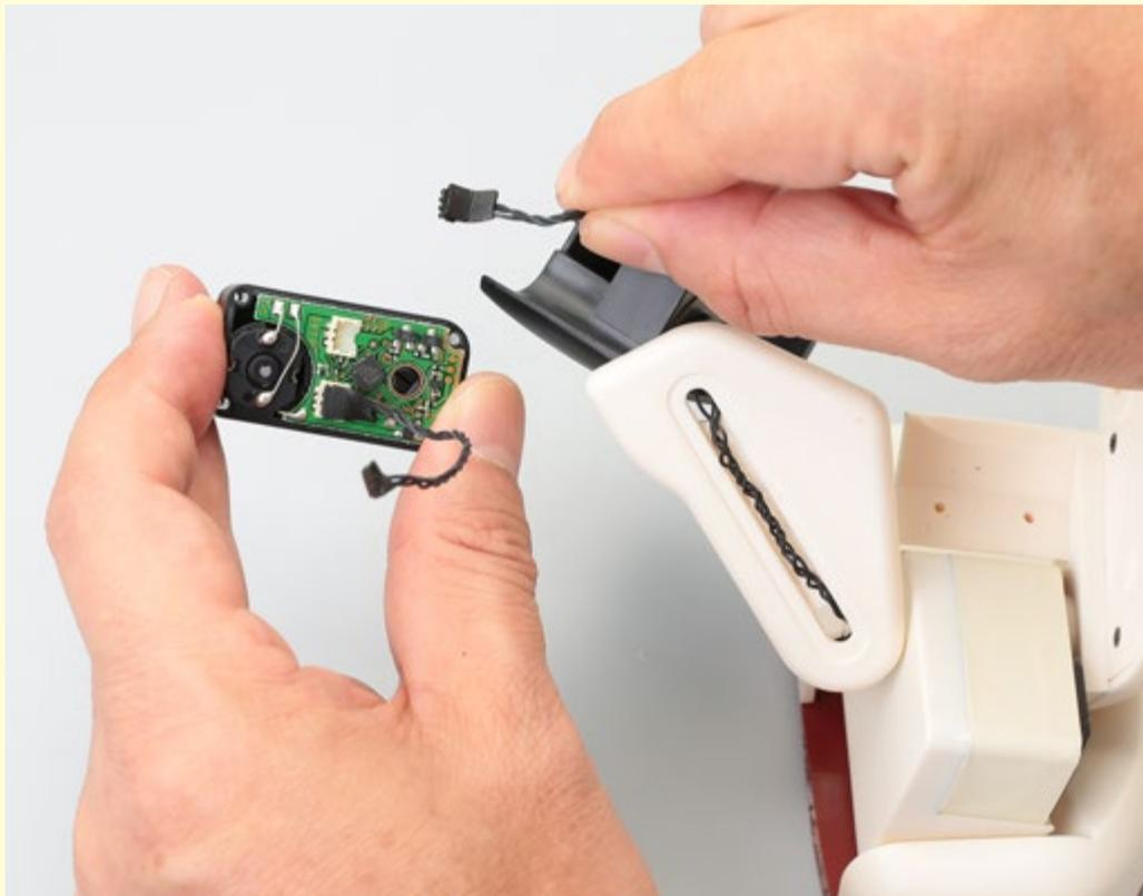
ひざサーボを取り外し、2本のサーボケーブルがきちんと接続されているかどうか確認する。続いて、下のサーボ(足首:縦回転)からのケーブルを取り外す。
