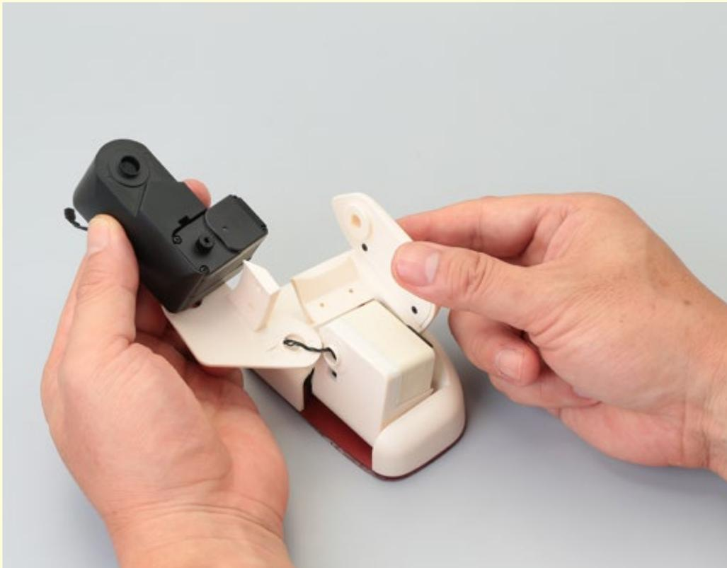
すね内側カバーを取り外し、ひざサーボのDカットからすねフレームを引き抜く。
