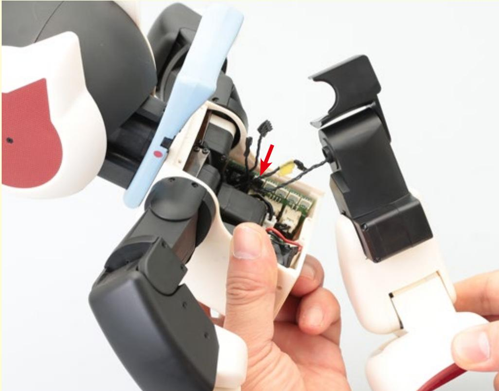
股関節:縦回転サーボから下の脚をチェックする。バッテリーを用意し、いちばん上のサーボコネクタにケーブルを接続して、スイッチをオンにしよう。
