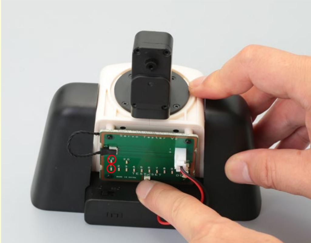
サーボに接続していたケーブルを取り外し、**テストボード**に付いている**ケーブル**を使って動作テストをする。
