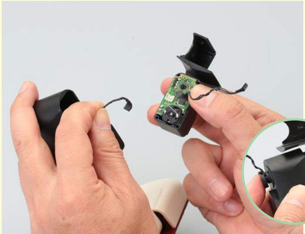
股関節:縦回転サーボを取り外し、2本のサーボケーブルがきちんと接続されているかどうか確認する。
