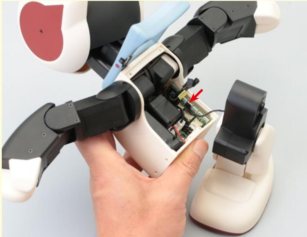
ひざサーボから下の脚をチェックする。バッテリーを用意し、2番目のサーボコネクターにケーブルを接続して、スイッチをオンにしよう。
