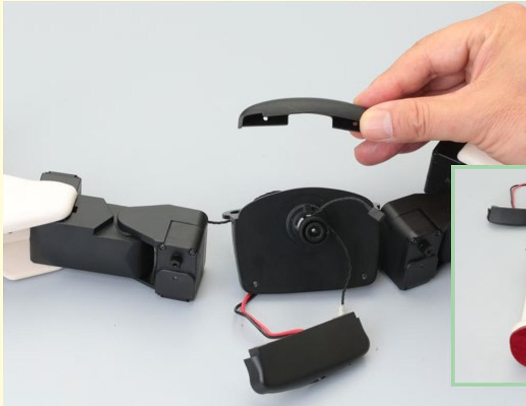
下腹カバー、腰フレームを取り外し、ヒップカバーのDカットから両脚を取り外す。
