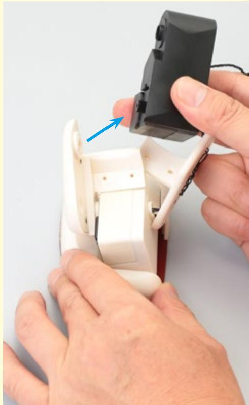
すね内側カバーを取り外し、すねフレームとひざ
