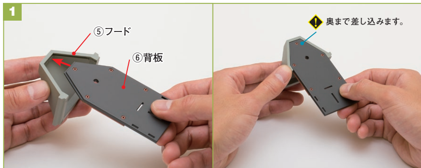
⑤フードの溝に、⑥背板を差し込みます。フードの端を少し開くようにして押し込むと、うまく入ります。
