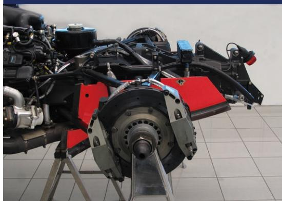
MP4/4のブレーキはブレンボ製のダブルキャリパーを採用している。フロントブレーキとリアブレーキの構造は同じだが、車体への取り付け角度が異なり、フロントブレーキではブレーキパッドが地面に対して垂直に、リアブレーキはやや角度をつけて取り付けられる。本モデルでは、ブレーキディスクやブレーキキャリパーの質感やディテールを細かく再現している。
