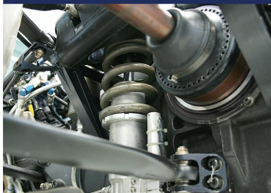
サスペンションは、地面からの衝撃や振動を緩和するとともに、マシンの操縦性にも影響を与える重要な部分だ。フロントにも同様のものがあるが、その形状は異なる。特にリアショックスプリングはフロントのものとは色やコイルの巻き数が違い、またショックアブソーバーにも専用のリザーバタンクが付くなど仕様が異なる。本モデルでも1:8のビッグスケールを生かし、細部まで再現している。
