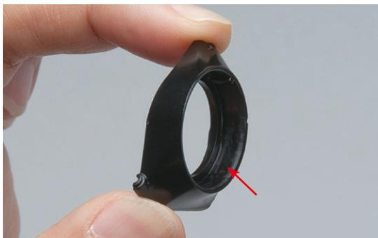
●リアアップライト(左中)とリアアップライト(左内)、それぞれの接着面となる部分の塗装をカッターの刃の削らない部分ではがす。
