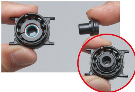
●CVジョイント(外)を指で押さえながらリアアップライト(左外)を裏返し、⑧リアアクスルをリアブレーキハブの穴の形に合わせて差し込む。
