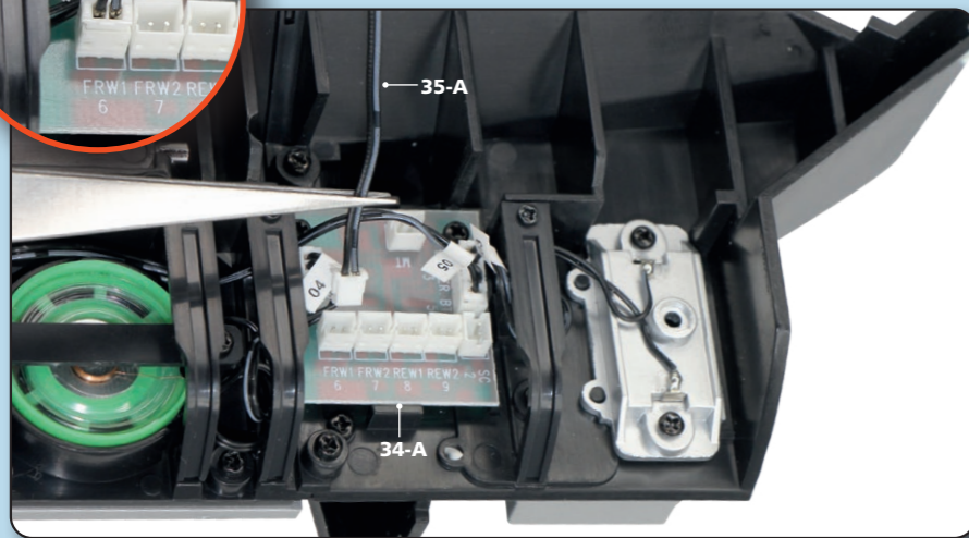
STEP 35-3 ケーブル07 (35-B) を ソケット「FRW2 7」に 差し込む。
