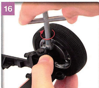
クロスレンチを使い、Tタイプのビスをねじ込む。
