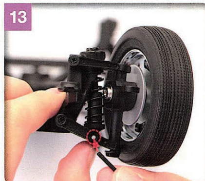
写真のように、ロワアーム側面のビス穴と、ダンパー下部のビス穴を合わせ、40号で提供したWタイプのビスを差し込む。ビスはロワアーム前側とダンパー下部のビス穴を貫通し、ロワアーム後ろ側のビス穴に突き当たる。
