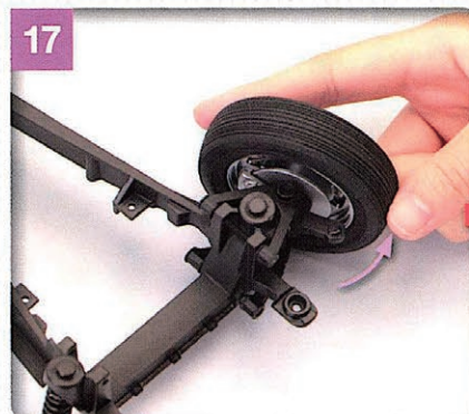
左フロントナックルを動かし、軽く左右に回転することを確認する。
