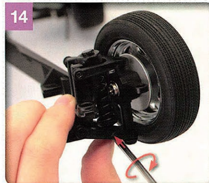
1番のプラスドライバーを使い、Wタイプのビスをゆっくりとねじ込む。ビスのアタマ部分がロワアームの側面と「ツライチ」の状態になればOKだ。
