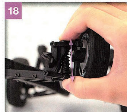
左フロントナックルを上下に動かし、ダンパーの伸縮とサスペンションの動作を確認しよう。
