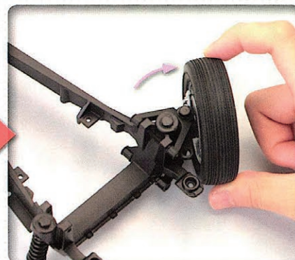
左フロントナックルを動かし、軽く左右に回転することを確認する。
