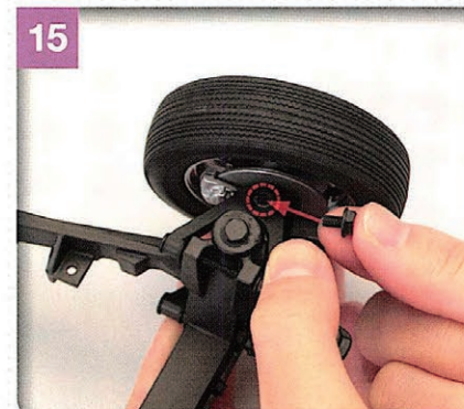
Tタイプのビスを用意し、写真で示した左フロントナックルのポストに設けられたビス穴へセットする。
