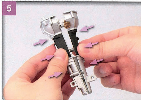
ミッションケースの内側に設けられた3カ所の取り付け部を合わせ、ゆっくりと左右から押し込んでいく。左右のミッションケースを“平行な状態”にしたままはめ込もう。
