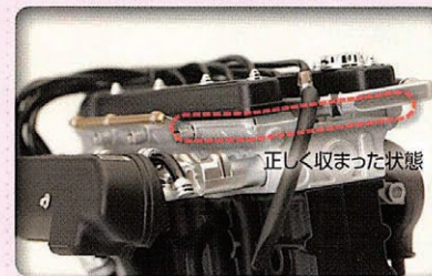
15 オイルパンをエンジンブロックに差し込んだとき、シリンダーヘッドが浮いてしまうことがある。これは、オイルパン側のポストとシリンダーブロック側のポストがかみ合っていないためだ。両方のポストがかみ合うよう、オイルパンを慎重に差し込もう。
