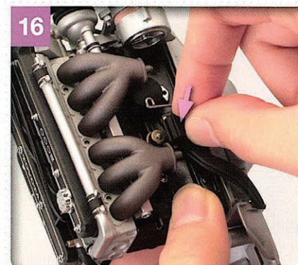
16 次に、写真で示した部分をエンジンブロックに押し込む。
