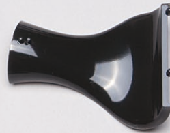
④ ターボインレットダクト(右・内)
