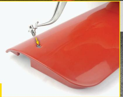
10-1(ドア・右)の外側の面の穴に、 10-2(ドアオープナー・右)の突起を差 し込む。ドアハンドルの向きは写真の ようにする。
