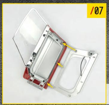
内部パネルを右側ドア内側に取り付ける。写真のように、合体させる位置で固定する。
