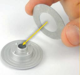
接着面を下にして、ディスクを2枚の94-3(ブレーキディスク)に合わせる。写真のように向きを合わせよう。
