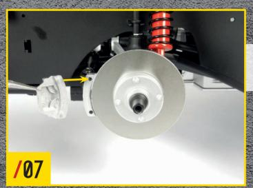
94-3(ブレーキディスク)と94-7(ブレーキキャリパー アウターセクション) 左部分(「L1」と刻印されている) を取りつける。写真のように向きをそろえる。
