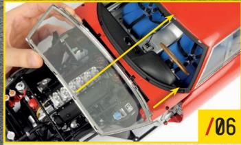
ボディを用意し、短い両面テープをはがしウィンドスクリーンを付ける。向きを確認する。
