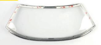
95-4(短い両面テープ)を台紙からはがし、写真のようにウィンドスクリーン内側に貼り付ける。
