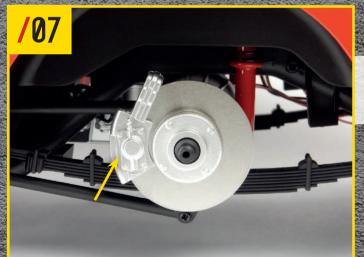
93-5 (ブレーキキャリパー アウターセクション) 左部分(「L」と刻印されている) をア取りつける。写真のように向きをそろえる。
