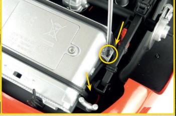
ブラケット端にあるスタッドでバッテリートレイをシャーシに取り付ける。 STAGES で保管しておいた2本のネジBを写真のようにねじ込む。そのあと、電池トレイを開け、単4電池を3本入れ、再びカバーをはめて閉じる。
