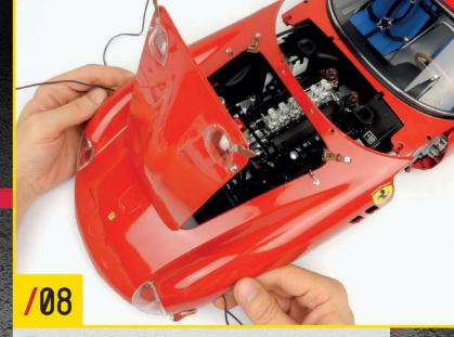
ボディのフロント部分を用意し、ボンネットを開ける。フロントヘッドライトケーブルを外側に引き出したら、ボンネットを閉じる。
