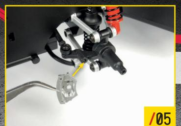
シャーシを用意する。94-6(ブレーキキャリパー インナーセクション) 左部分(「L」と刻印されている) を写真のようにリアアクスルシャフト左の位置にはめ込む。向きを確認する。
