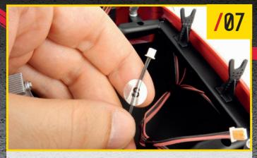
次の組み立て作業の目印になるように、スピーカーケーブル(黒と白のコネクター)に95-5(スピーカーケーブルステッカー)を貼っておく。
