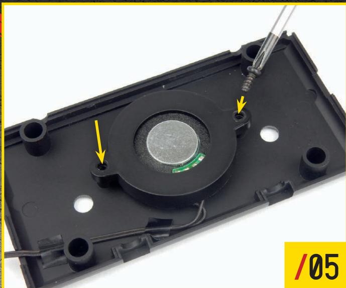
2本のネジBでロックリングを固定する。
