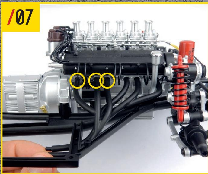
リア右排気口ホースの端にあるスタッドを写真のようにシャーシの穴に差し込む。
