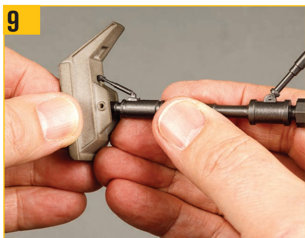
斜めの支柱にある小さな位置決めピンを穴に合わせ、メイン支柱の端にある穴を側面の穴に合わせる。
