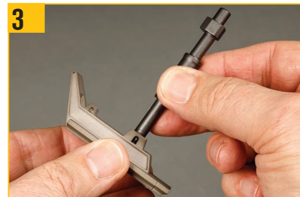
支柱の端を後方着陸脚の大きなブラケットに合わせ、取り付け穴を揃える。
