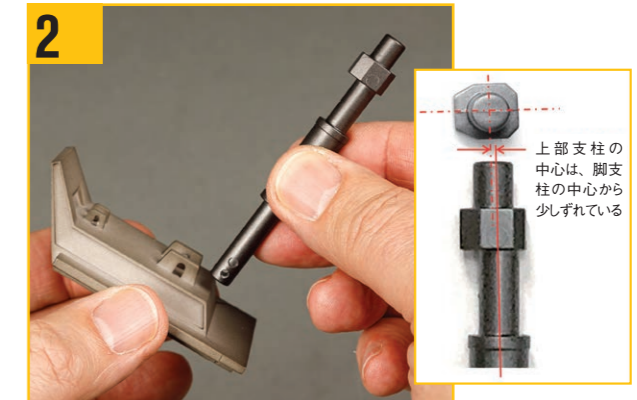
写真のように後方着陸脚に後方着陸脚支柱を合わせる。挿入図を参考に方向を間違えないように注意する。
