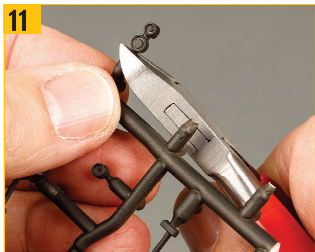
写真の「8」のように見えるディテールパーツを切り離す。
