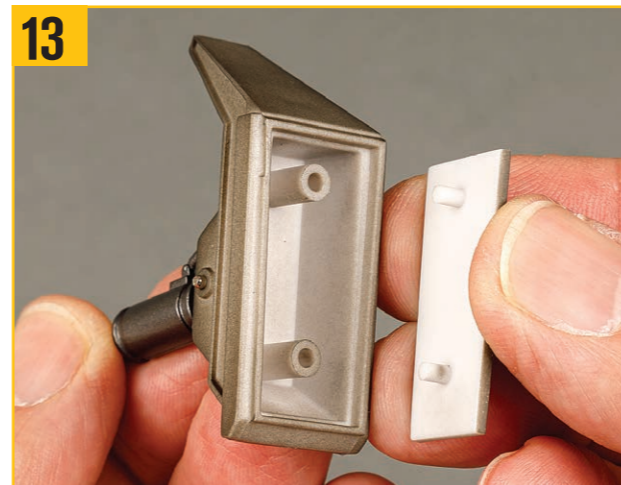
前方着陸脚ベースの2つのピンを前方着陸脚の穴に合わせる。前方着陸脚ベースは一方方向にしか収まらないことに注意する。
