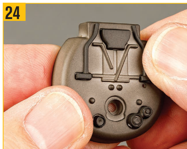
ステップ22と同様に、ディテールパーツの端を写真のくぼみに取り付ける。
