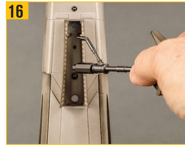
もう一端のメイン支柱と斜めの支柱を写真の穴に差し込み、前方着陸脚を取り付ける。
