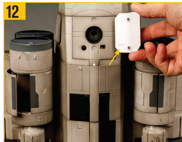
12 写真のようにカーゴハッチを用意する。小さな長方形のくぼみ（矢印）に注意する。
