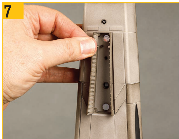
手順4~5と同様に、右舷開放扉を取り付ける。
