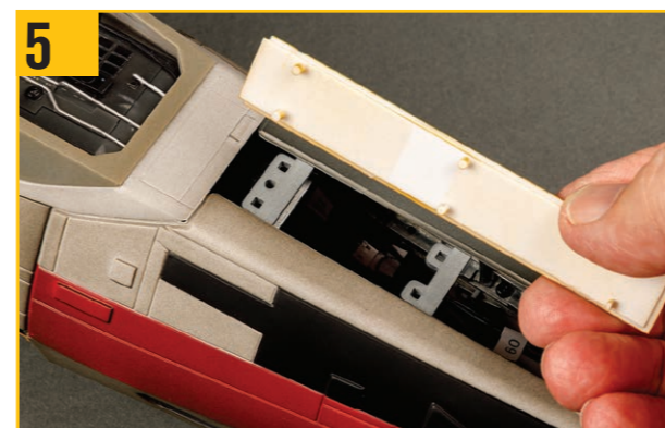
写真のように中央トップパネルを用意し、手順6に示すように後端を取り付ける。
