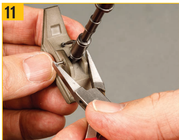
ピボットピンをゆっくりと押し込み、前方着陸脚全体に通す。
