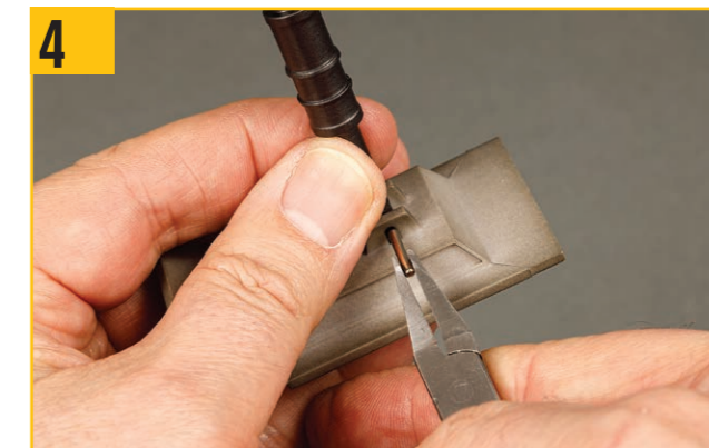
後方ピボットピン(前方ピボットピンよりも長い)を穴に通す。
