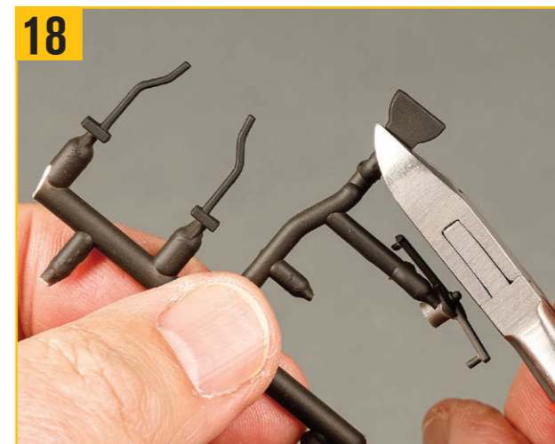
次に、写真のディテールパーツを、直線のエッジの近くで切り離す。
