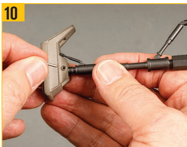
ピボットピンを前方着陸脚の側面と支柱の穴に通す。
