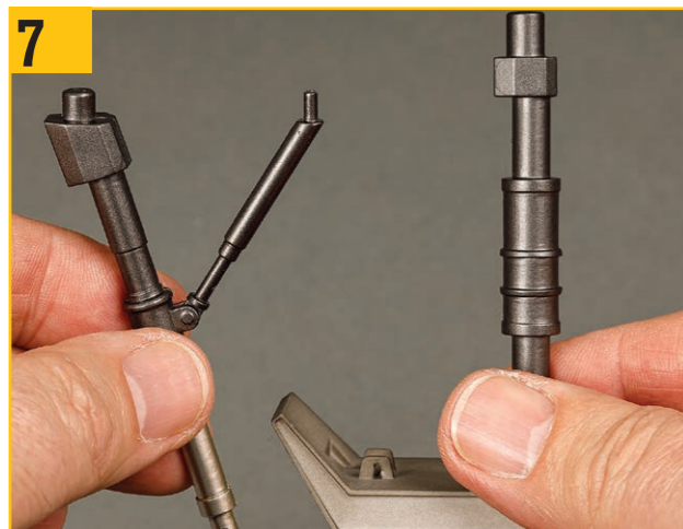
写真のように後方着陸脚前方支柱を用意する。
