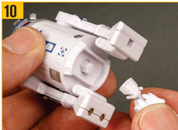
10 中央脚を取り外して、頭部の駆動スピンドルを露出させる。
