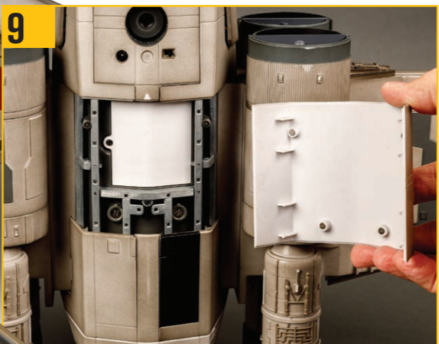
9 バッテリーボックスカバーは写真のように、3つの小さな磁石で固定される。
