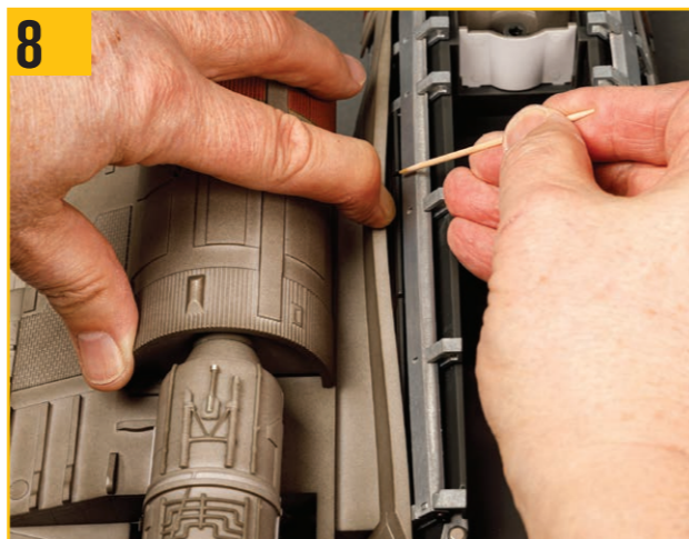
長辺に隙間ができないように、位置決めピンに楊枝で瞬間接着剤を一滴垂らすとよいだろう。
