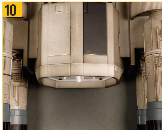
10 後部胴体サラウンドがパネルとすべて同じ高さになっていることを確認する。
