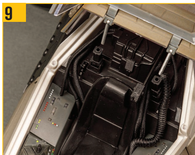
9 コックピットキャノピーを用意し、2本のピストンロッドをストラットの穴に合わせる。
