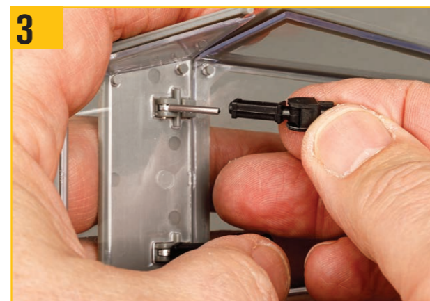
ストラットを2本のピストンロッドから一時的に引き抜く。
