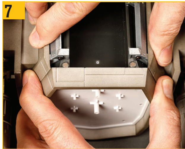
7 後部胴体サラウンドが胴体パネルと平らに収まっていることを確認する。
