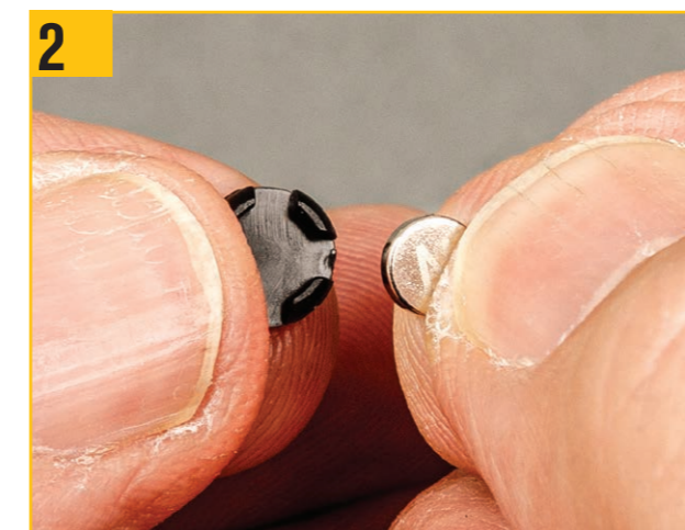
2 リテーナーと磁石を用意し、「N」の刻印がある面が上になるようにする。
