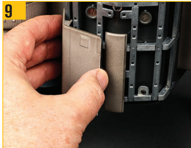
ピンをフレームワークに取り付ける。
