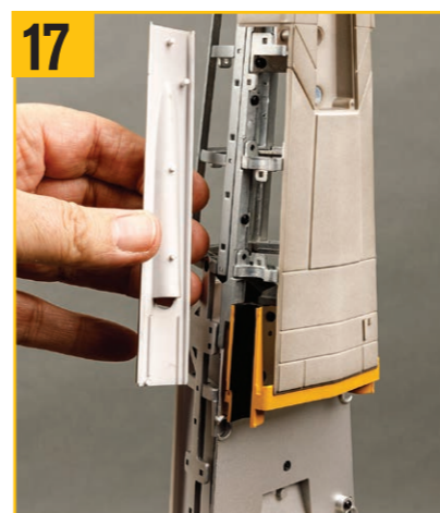
17 右舷魚雷チャンネルを用意し、取り付けピンをフレームの穴に合わせる。
