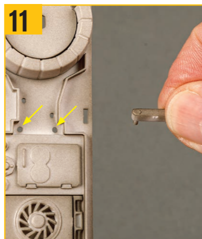
11 写真の穴に一致する2つの位置決めピンが付いている細長いパーツを用意する。
