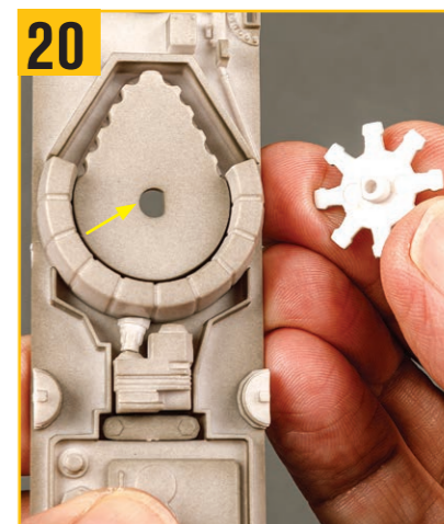
20 このディテールパーツの裏側にあるD字型のピンを写真の穴に合わせる。
