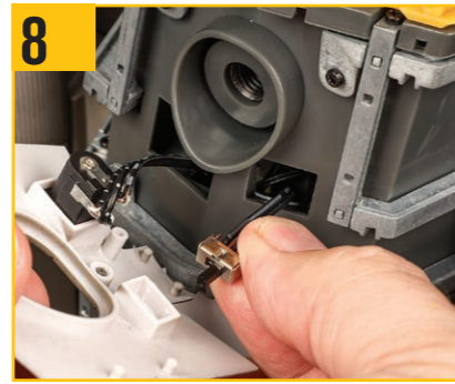
8 ワイヤを引っ張らないように注意しながら、カーゴベイ船体プレートの穴にスイッチを合わせる。
