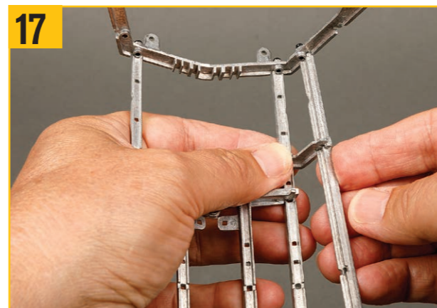
17 2本の位置決めピンを右ベースストラットと右ストラットの穴に合わせる。
