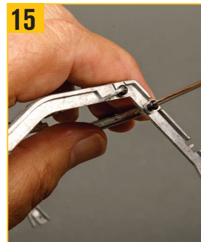
15 手順16~20で右ストラットが動くように、XW01ネジで緩く固定する。
