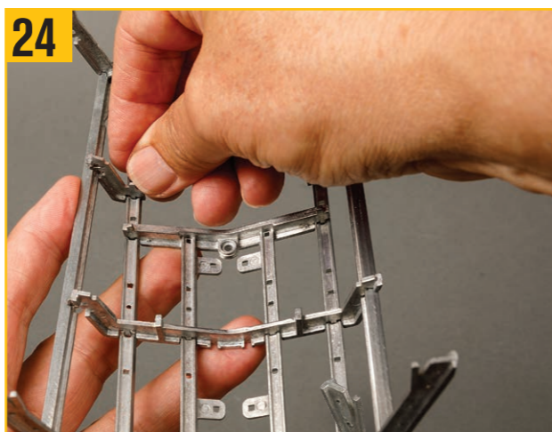
24 手順17と同様に、左フレームを合わせ、中央下部フレームの位置決めピンを左ストラットの穴に合わせる。
