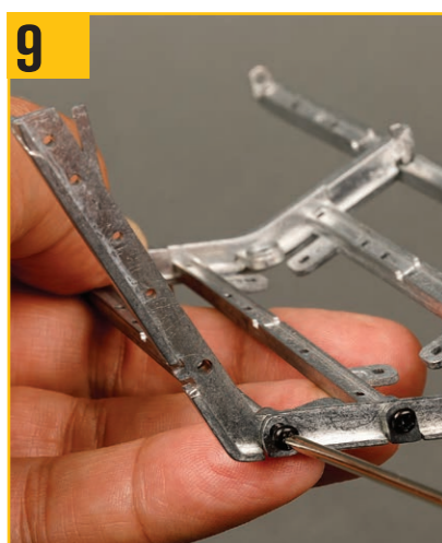
9 XW01ネジで左ベースストラットを固定する。
