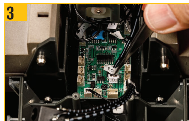
片方のプラグを回路基板のソケット09に差し込み、正しい方向に収まっていることを確認する。ピンセットがあると便利だ。
