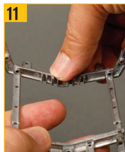
11 ベースストラットの端に下部前方フレームを合わせる。
