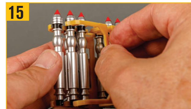
15 魚雷の上部にある穴に6対の位置決めピンをはめ込むことができる。
