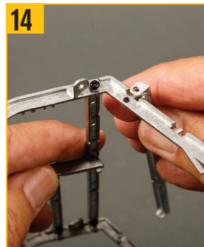
14 端を下部前方フレームに合わせる。
