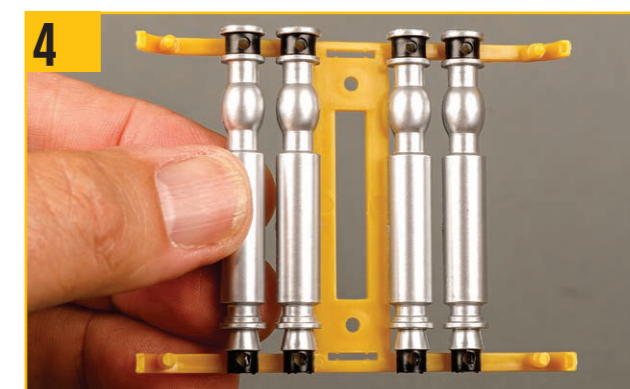
4 手順2~3と同様に、4つの魚雷本体をすべて組み立てる。
