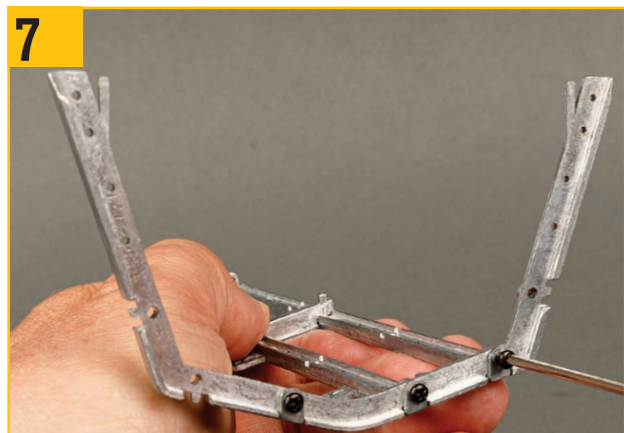
7 右ベースストラットの中央がベースフレームに固定される。XW01ネジで右ベースストラットの端を固定する。
