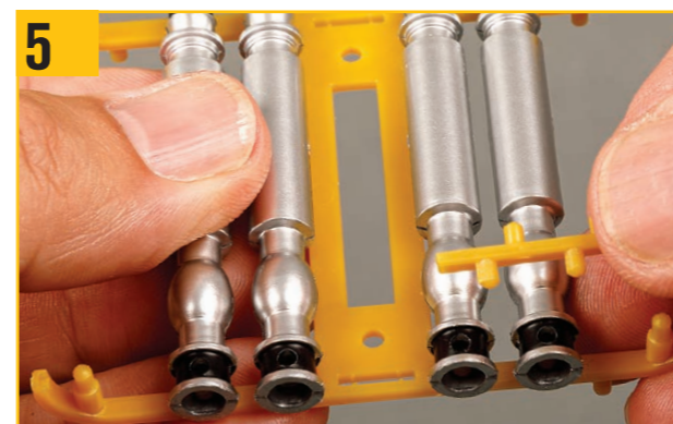
5 ピンが穴と同じ形状の魚雷ラックスペーサーを用意する。写真のように持ち、ピンを魚雷本体の穴に合わせる。
