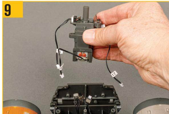
9 ステージ70で組み立てたドロイドモーターとギアボックスパーツを用意する。これには、15、16、17のラベルが付いた3つのリード線があり、写真のように後部胴体の端に持ってくる。
