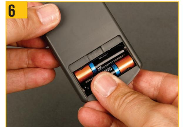
6 写真のように単4形乾電池2本を取り付ける。マイナス(-)端子をバネのある方に向けて、2本が逆向きになるように入れる。
