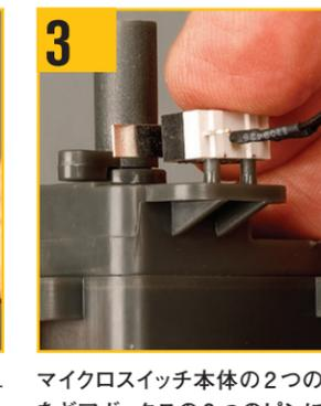
3 マイクロスイッチ本体の2つの穴をギアボックスの2つのピンに押し込む。
