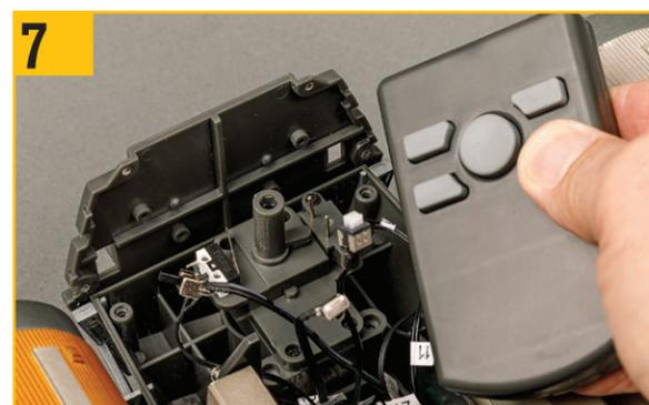
7 右下のボタンを押して、ドロイドモーターのスピンドルが回転することを確認する。
