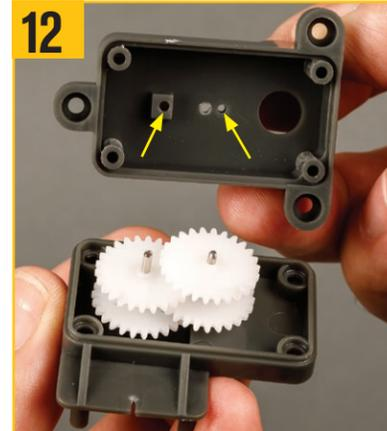
ギアボックスカバーを用意する。スピンドルの端は、真ん中の大きな穴ではなく、写真の2つの穴に収まる。
