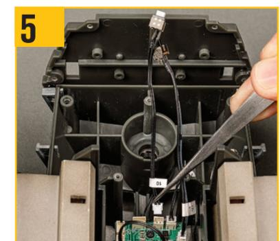
5 スイッチを回路基板のソケット10に差し込む。
