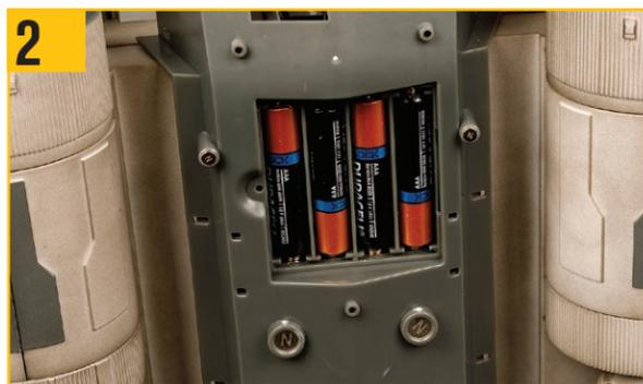
2 写真のように4本の単4形乾電池を取り付ける。マイナス(-)端子をバネのある方に向けて、4本が逆向きになるように入れる。
