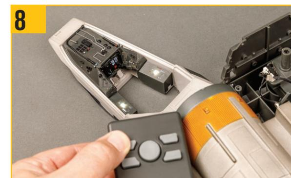
8 左上のボタンを押して、コックピットの計器灯が点灯することを確認する。
