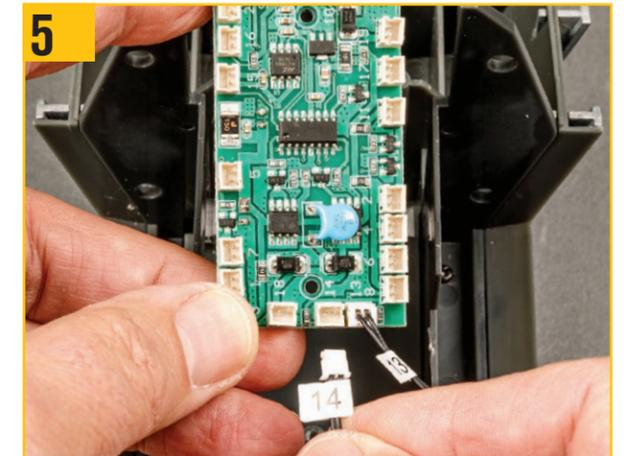
14とマークされたリード線に対応するソケットに差し込む。これにより、翼が完全に開いたことを検知するスイッチが接続される。
