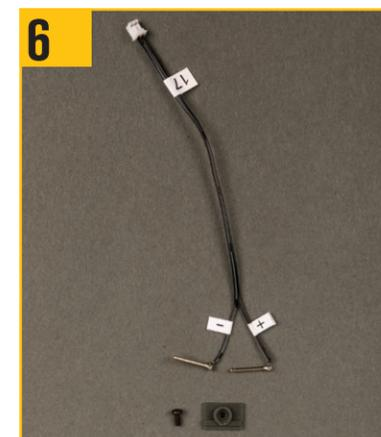
6 ドロイドコンタクト、コンタクトハウジング、コンタクトカバー、およびXW10ネジを用意する。
