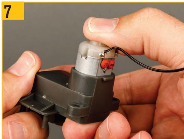
7 駆動ピニオンが減速ギアと噛み合っていることを確認して、モーターを完全に押し込む。
