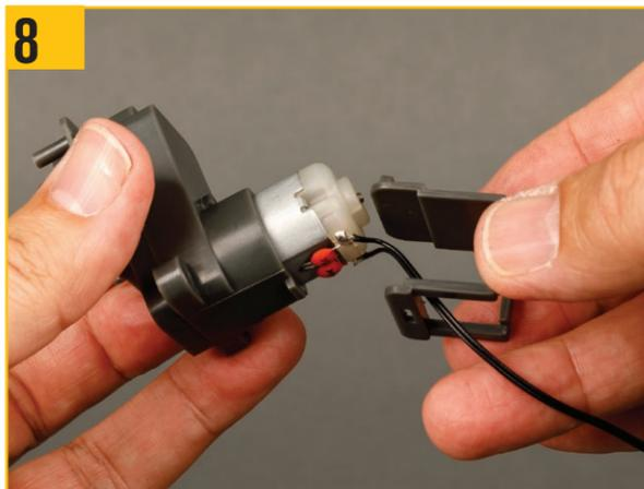
8 モーターマウントをモーターからつながるワイヤーを通して取り付けると、モーターマウントの端にあるスロットを滑り込ませることができる。
