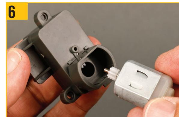
写真のように電気モーターをギアボックスのハウジングに取り付ける。
