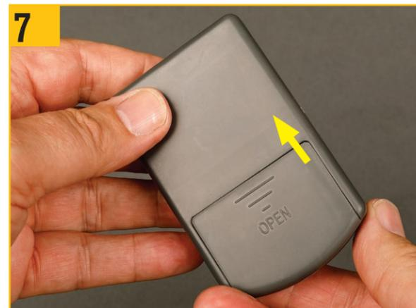
7 電池収納部カバーを再度取り付ける。
