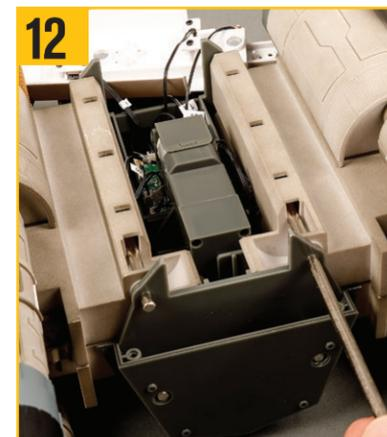
最後のスピンドルを挿入して、固定する。
