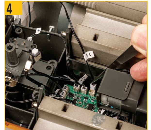
4 そのリード線(ラベル11)を回路基板のソケット11に差し込む。
