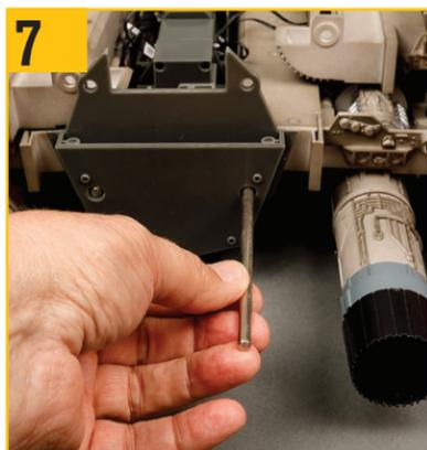
左舷と同じように、別のスピンドルを使用して右舷翼を固定する。
