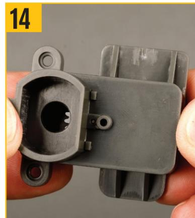
ギアボックスカバーをギアボックスケーシングに押し込む。
