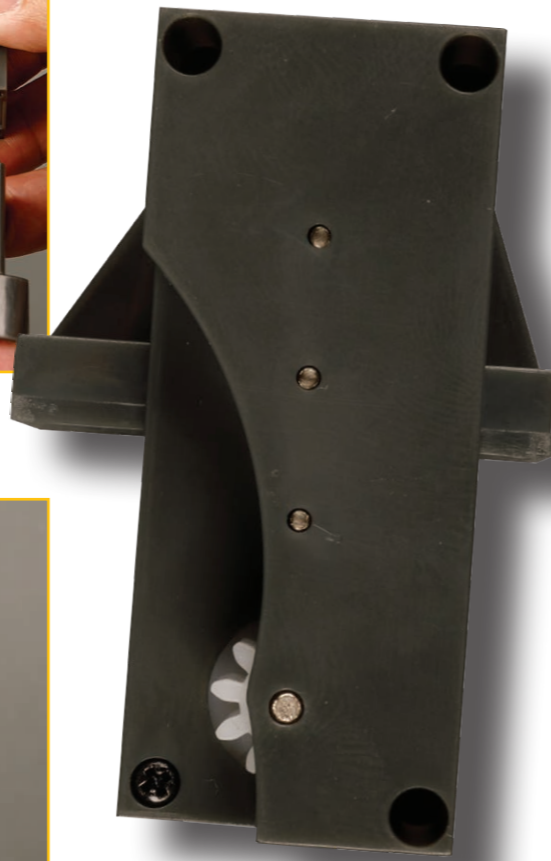
これでギアボックスの組み立ては完了だ。ここに見える突出した歯車は、非常に低速で回転して翼を作動させる。
