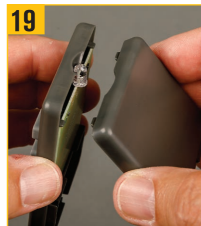
19 リモートコントロールの背面パネルの上部にある2つのタブを、フロントパネルのスロットに引っ掛ける。
