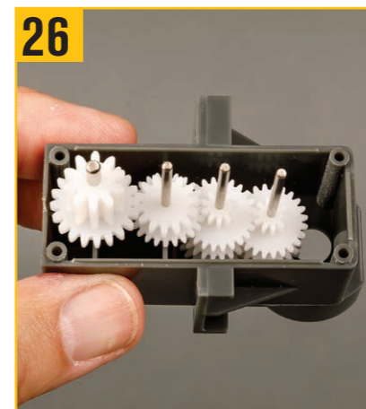
26 大きい歯車がステップ22～24のギアの小さい歯車と噛み合うように、スピンドルに取り付ける。
