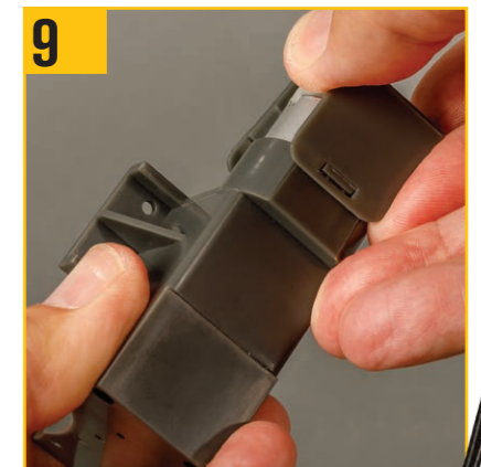
9 マウントの外側の端にあるスロットを、ギアボックスの端にある突出したタブに合わせる。
