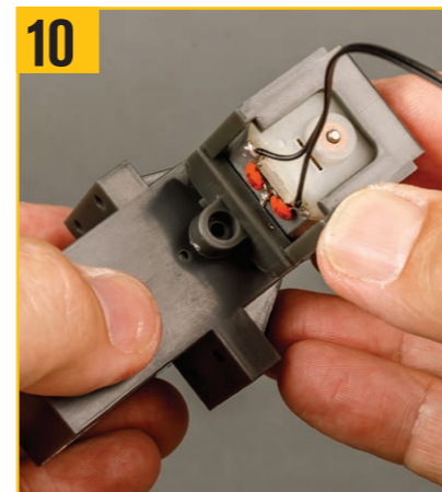
10 マウントの固定ラグをギアボックスの穴に合わせる。
