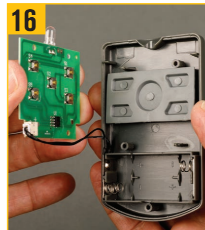
16 写真のように回路基板をフロントパネルに合わせる。
