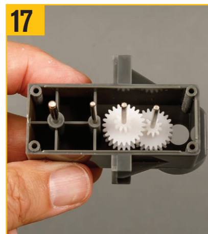
17 大きな歯車がステップ14～15のギアの小さな歯車と噛み合うように、スピンドルに取り付ける。
