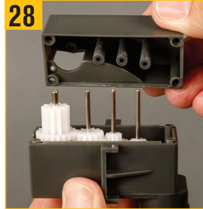
28 4つの突出したスピンドルをギアボックスカバーの取り付け穴に注意して合わせる。
