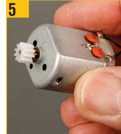
5 ピニオンの外面は、ドライブシャフトの端と同じ高さにする必要がある。
