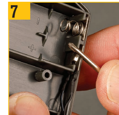
7 ドライバーの側面を使用して、両方の端子をスロットに完全に押し込む。
