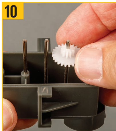
10 6つの減速ギアの1つを写真の最後のスピンドルに滑り込ませ、小さな歯車を一番上にする。
