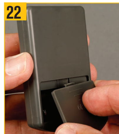
22 バッテリーカバーの上部にあるタブを背面パネルのスロットに引っ掛ける。
