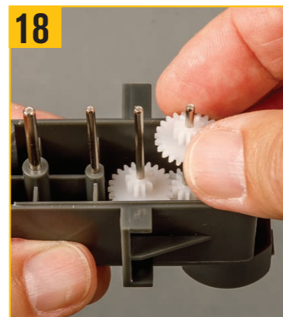
18 同じように、最初のスピンドルに減速ギアを取り付ける。
