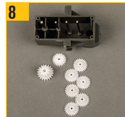
8 小さなドライブピンオンを除いた、大型ドライブギア、中型ギア、減速ギア×6を用意する。
