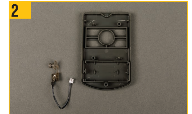
2 リモートコントロールのフロントパネルと、配線が接続されているバッテリー端子から組み立てを開始する。
