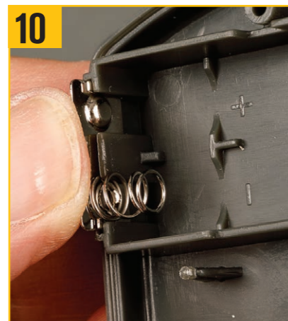
10 背面プレートをフロントパネルのスロットに押し込む。
