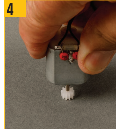
4 作業面を使用してしっかりとシャフトに押し込む。
