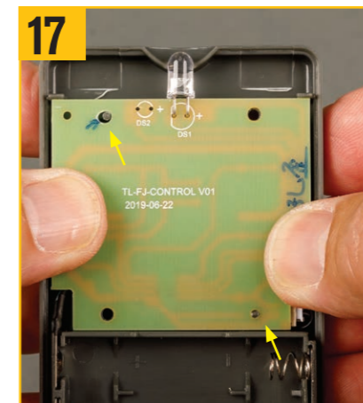
17 回路基板をフロントパネルにそっと押し込み、矢印の付いた位置決めピンに取り付ける。パネル上部の穴に透明ダイオードが丁度合うように注意する。
