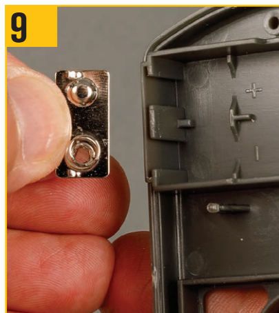
9 バッテリー端子ブリッジを用意し、写真のようにフロントパネルに合わせる。
