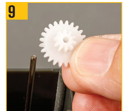
9 6つの減速ギアは同じで、それぞれの中央に小さな穴と内側に小さな歯車がある。これらのギアは、ステップ10~21で使用される。
