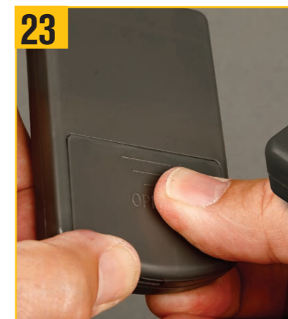
23 次に、カチッと音が鳴り所定の位置に収まるまでカバーを上をスライドさせ、ぴったりとはめ込む。
