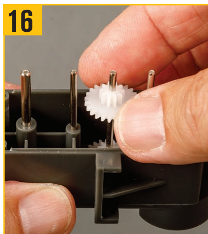
16 同じように、減速ギアを2番目のスピンドルに取り付ける。
