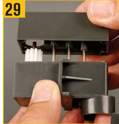
29 スピンドルやギアを露出させないように注意しながら、カバーをスピンドルに押し付ける。
