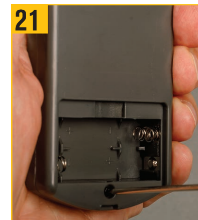
21 XW03ネジでパネルを固定する。
