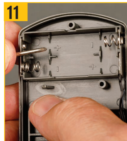
11 ドライバーの側面を使用して、背面プレートをスロットに完全に押し込む。
