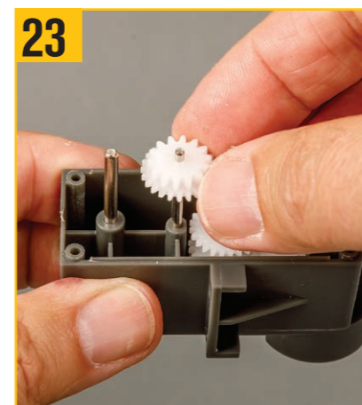
23 中間ギアを3番目のスピンドルに滑り込ませ、小さい方の歯車を上にする。
