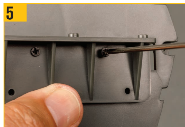
反対側のもう1つの穴もXW05ネジで固定する。
