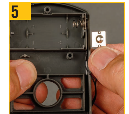
5 突起のある端子を写真のようにフロントパネルに合わせる。
