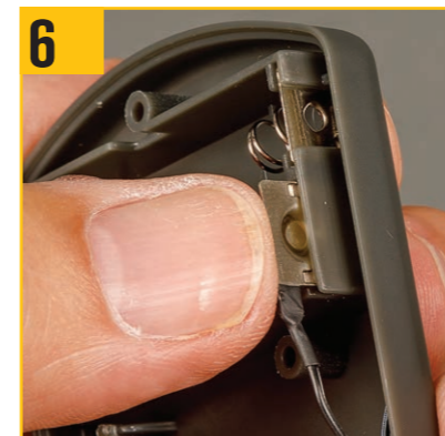
6 端子をフロントパネルのスロットに押し込む。
