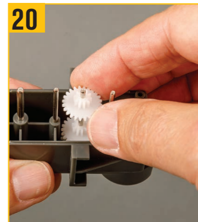
20 同じように、減速ギアを2番目のスピンドルに取り付ける。
