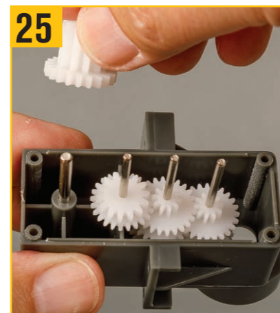
25 残りの大型ドライブギアには、ギアボックスの端にある太いスピンドルに合うように大きな穴がある。
