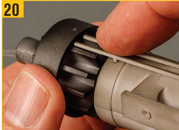
20 必要であればサイドチューブのハウジングへの押し込みを緩める。
