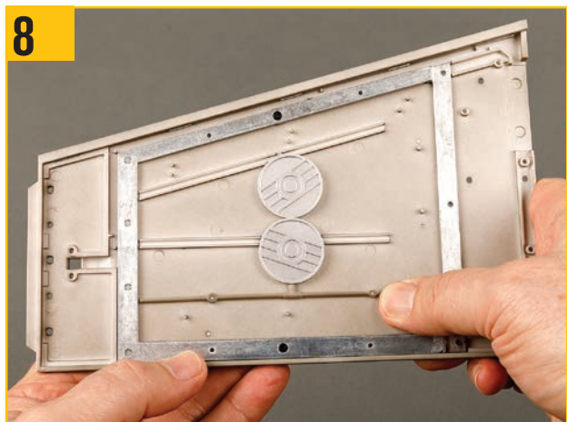
8 前縁の導管を左舷上翼のピンに押し込む。
