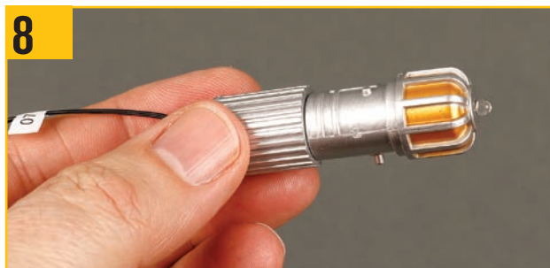
8 写真のように中央ユニオンをジェネレーター本体に押し込む。
