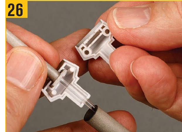
26 サプレッサーマウントの2つのパーツのピンと穴を合わせて、押し込む。
