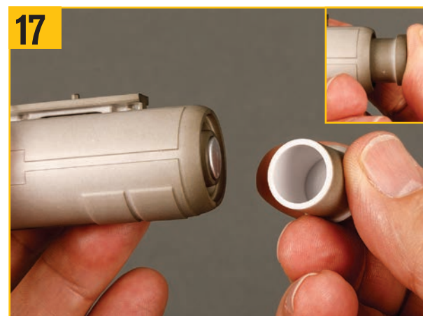
17 リアエンドキャップをハウジングの端に合わせて押し込む。
