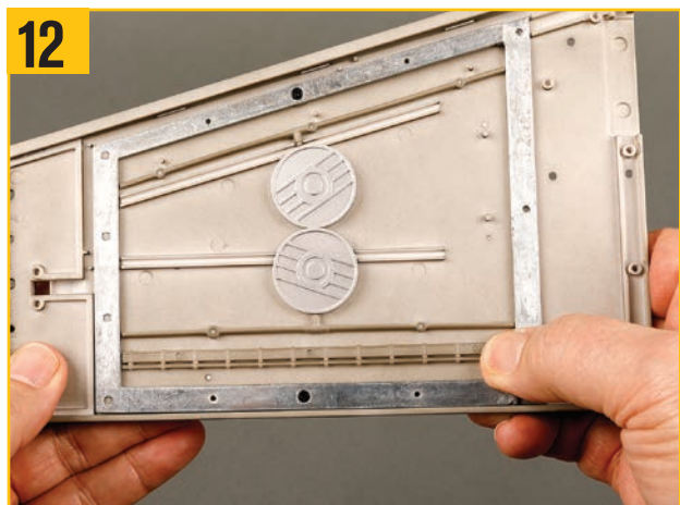
12 前縁の配管を左舷上翼のピンに押し込む。
