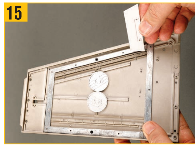
15 翼根の留め具を用意し、2つの穴を右舷上翼の対応するピンに合わせる。
