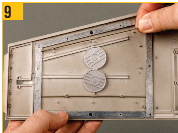
9 後縁の導管を用意し、導管の3つの穴を左舷上翼のピンに合わせる。
