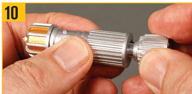
10 エンドキャップを中央ユニオンに押し込み、ワイヤーをユニオンの溝から出す。
