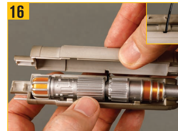
16 ジェネレーターハウジングの残りの半分を取り付ける。LEDワイヤーが写真のようにハウジングの側面の切り欠きから出ていることを確認する。
