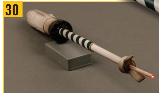
30 テストに使用したバッテリーボックスを用意し、レーザーキャノンのリード線を差し込み、チップが点灯することを確認する。
