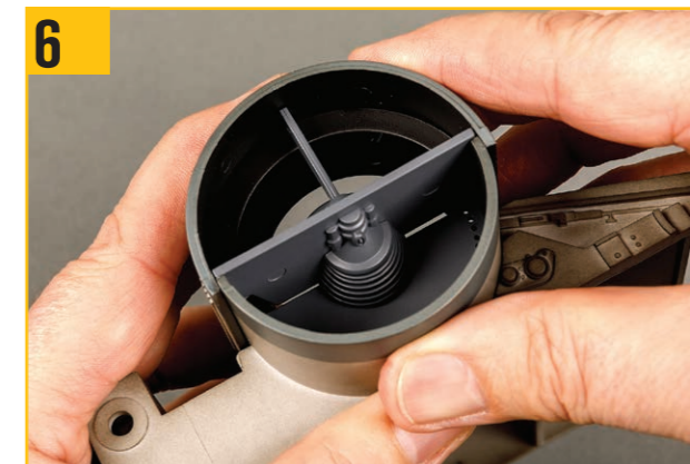
6 そして冷却羽根の端にあるピンをケーシング前面の対応する穴に差し込む。
