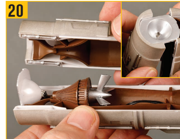
20 そして、リフレクターがエンジンケーシングのスロットに確実に収まるようにする。(右上挿入写真参照)
