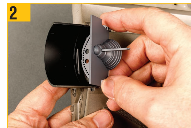
2 上部シュラウドをエンジンマウントの半円形の吸気口にある2つの湾曲したスロットに合わせる。
