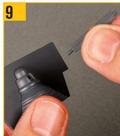
9 冷却羽根の長い方のピンをジャイロコーン下部の穴に取り付ける。
