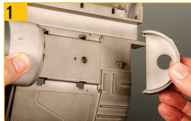
1 エンジンマウントと下部リアエンジンケーシングを写真のように持つ。
