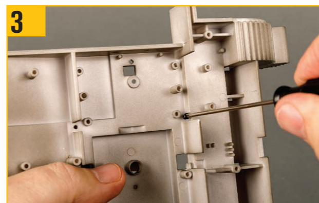
3 パーツ全体を裏返し、XW06ネジで写真に示す穴をねじ止めし、エンジンケーシングを固定する。
