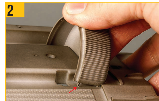
2 矢印の穴と対応するピンを確認し、ケーシングを写真の位置に押し込む。
