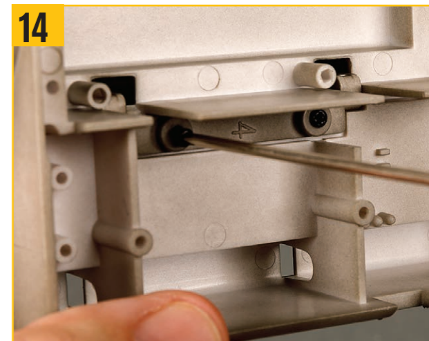
14 ヒンジ固定具を所定の位置に置き、2本のXW06ネジでヒンジ固定具を固定する。
