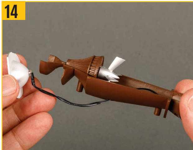
14 リフレクターが写真の位置にくるまでリード線を通す。
