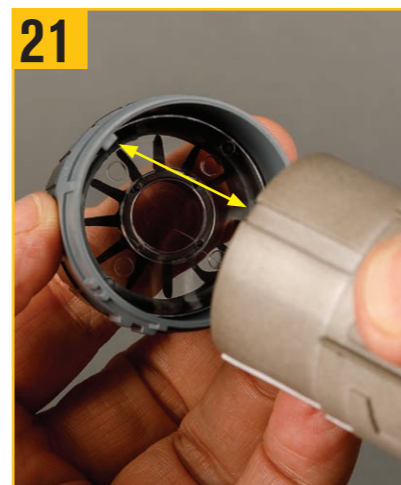
21 写真のようにスラストノズルとエンジンケーシングのリップとノッチの位置を合わせる。
