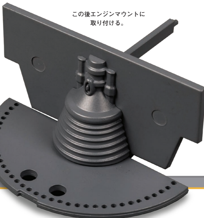
11 ジャイロコーン上部にある2つのピンを上部シュラウドの対応する穴に合わせて、部品を押し込む。 ※ピンの太さと穴の大きさは異なる。
