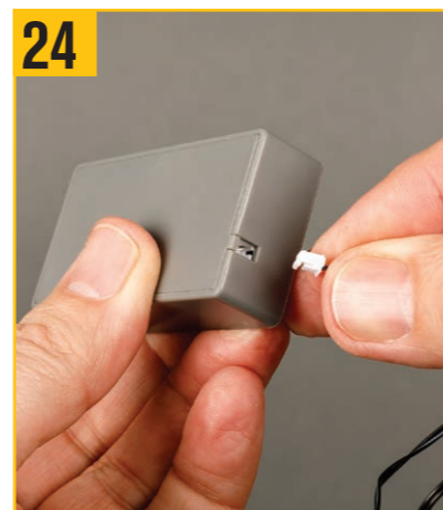
24 以前テストに使用したバッテリーボックスを用意し、エンジンLEDからリード線を差し込む。
