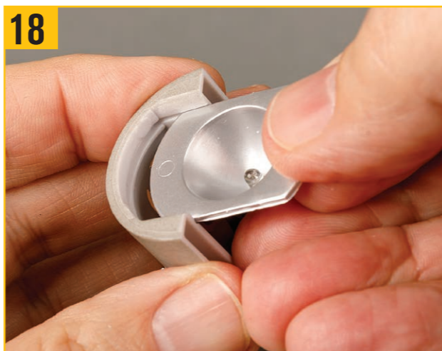
18 リフレクターの湾曲した端をケーシングの写真に示すスロットに取り付ける。ノッチのある端が上部にくる事を確認する。
