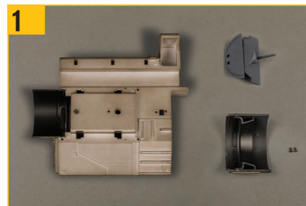
1 組み立てた2つのエンジンパーツ、ステージ40で組み立てたエンジンマウントと2つのXW06ネジを用意する。
