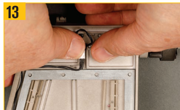
プラグとソケットを翼の所定の位置に押し込み、余った配線をきれいに巻く。
