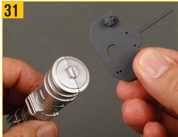
31 内部隔壁の大きなD字型の穴に、パワー入力ユニットの端にある対応するラグを合わせる。
