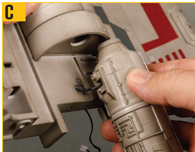
C リード線を穴に通し、エンジンの取り付け穴と位置決めピンをマウントの対応する穴に合わせる。
