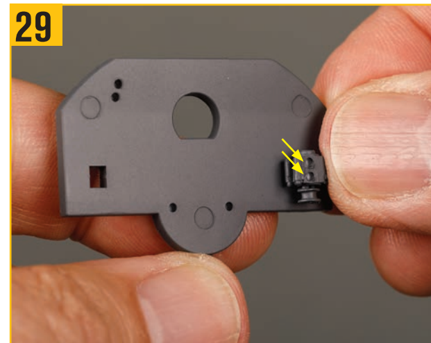
29 写真のように2つの穴があるディテールパーツを用意し、背面の四角いピンを隔壁の右側の穴に押し込む。
