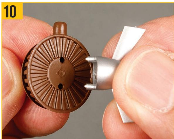
ターボインペラーの2本のピンをターボ発電機本体の対応する穴に合わせる。
