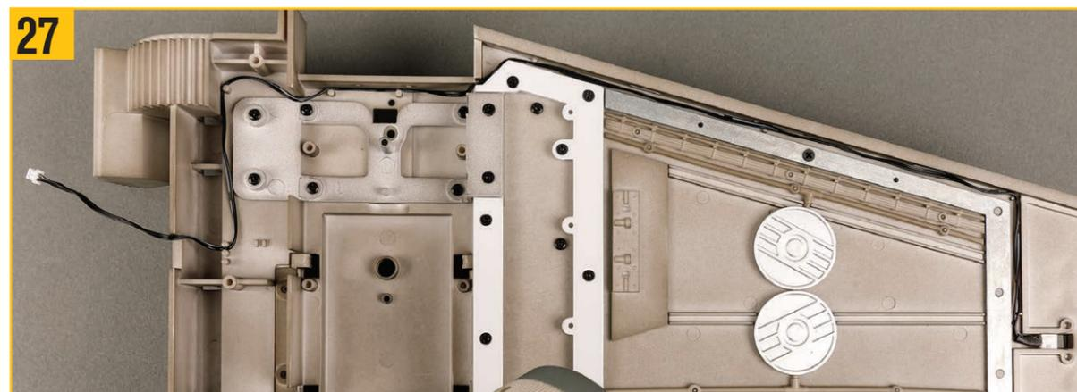
リード線は写真のように配線する。端のプラグは翼の付け根の中央の切り込みから出るようにする。
