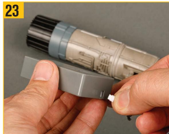
前のテストで使用したバッテリーボックスを用意し、エンジンLEDからリード線を差し込む。
