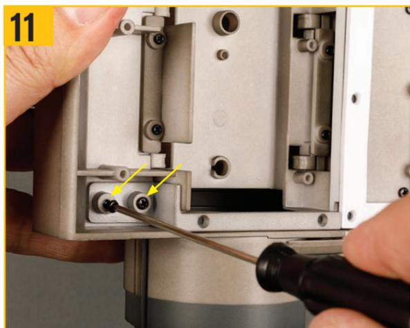
11 写真の2つの穴をXW02ネジで締めて、サポートブラケットを固定する。
