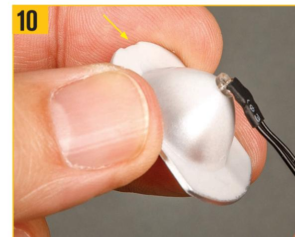
矢印の付いたノッチの反対側へ、リフレクターの曲線に沿ってワイヤーを慎重に曲げる。
