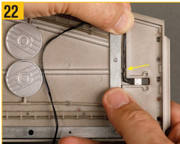
必要に応じてドライバーの先端を使用して、リード線を翼の外縁の周りに配線する。
