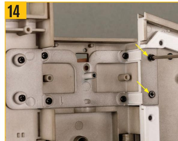
14 エンジンマウントブレースと内側のウィングフレームの写真の2つの穴をXW04ネジで締める。
