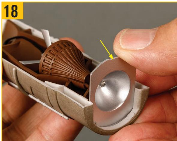
リフレクターの湾曲した端をケーシングの写真に示すスロットに取り付ける。矢印の付いたノッチのある端が上部にくる事を確認する。
