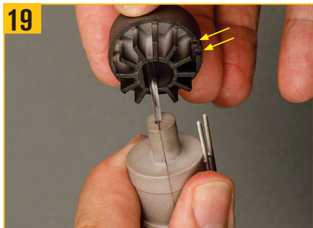
19 フロントキャップを光ファイバーに通す。ハウジングの端とフロントキャップの穴はD字型であるため、一方向にのみフィットする。2つのサイドチューブが指定の穴に確実に収まるようにする。
