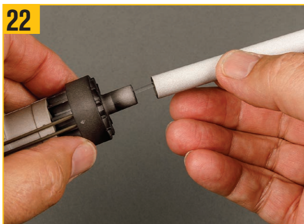
22 ステージ19で作成した砲身に光ファイバーを通し、砲身をフロントキャップに取り付ける。
