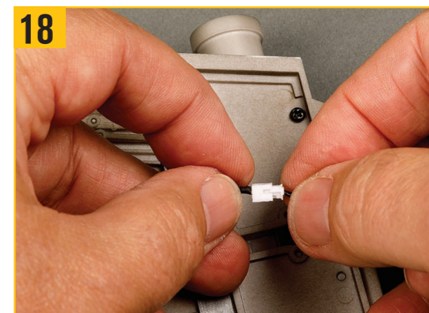
18 ステップ13のリード線のプラグを、翼の穴の横にあるワイヤーのソケットに差し込む。
