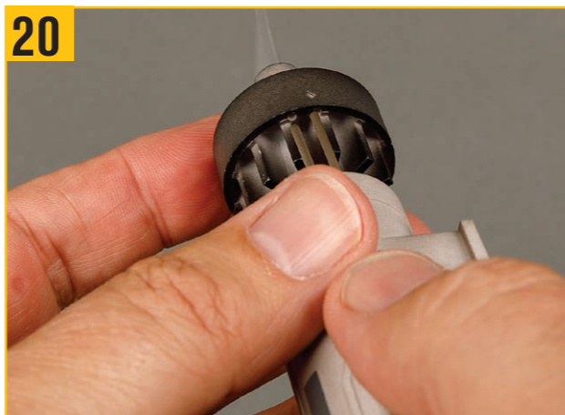
20 エンドキャップを所定の位置にしっかりと押し込み、ステップ19の写真に示されている穴にサイドチューブが正しく配置されていることを確認する。
