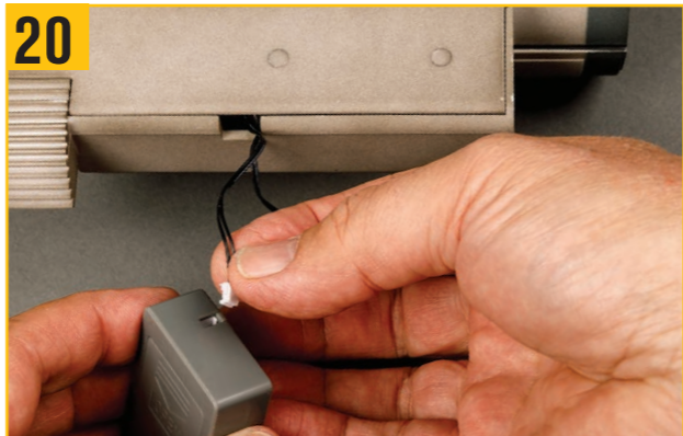
20 接続が機能していることをテストするには、翼のもう一方の端にあるプラグを接続して確認する。(1つはエンジンライト用で、もう1つはレーザーキャノン用) 提供のケーブルに識別ラベルがない場合には、レーザーキャノンは「01」、エンジンライトは「02」のラベルを貼り付けてください。後で基板に取り付ける際の識別番号となります
