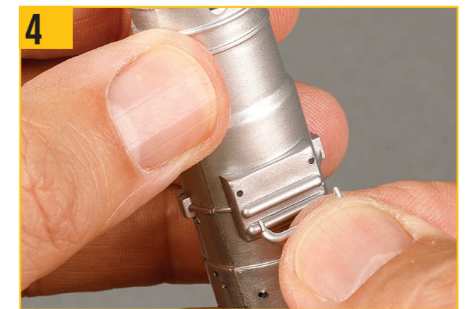
4 一番短い小パイプを用意し、両端のピンをパワー入力ユニットの上半分の2つの穴に合わせる。
