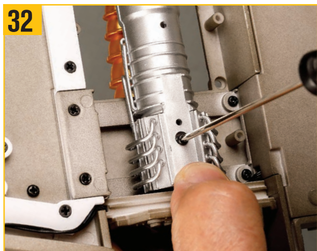
32 XW02ネジでパワー入力ユニットの端をエンジンマウントに固定する。
