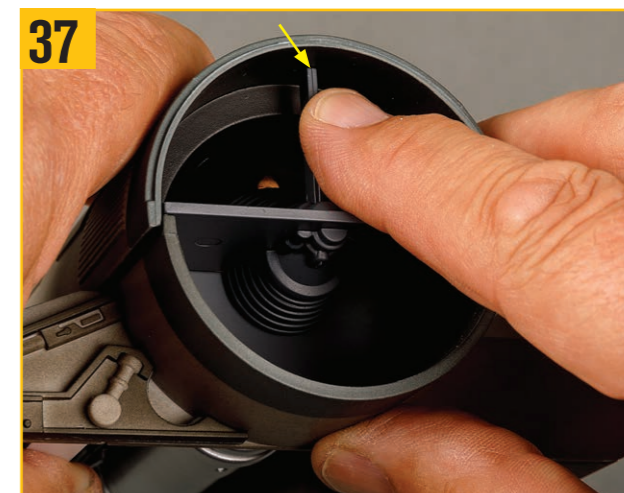
37 ケーシングの前面を平らにするために、冷却羽根の端にあるピンを写真の指定の穴に取り付ける必要がある。
