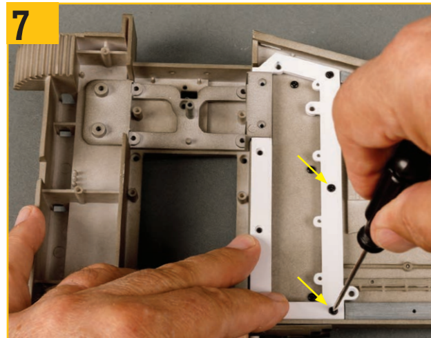
その後、矢印の穴をXW04ネジでねじ止める。
