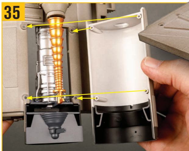
35 上部エンジンケーシング(ステージ10で組み立てたもの)の4つのラグをエンジンマウントの穴に合わせる。
