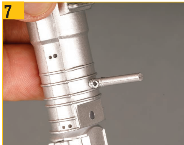
写真のようにパイプを奥まで押し込む。
