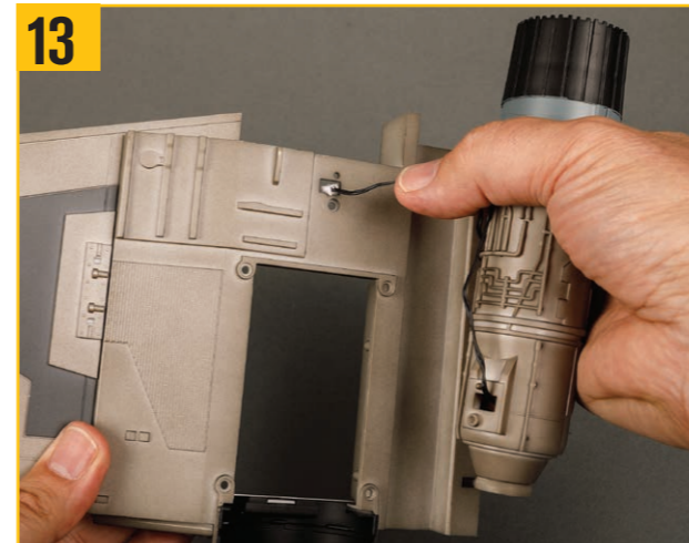
エンジンLEDのリード線をエンジンマウントの写真の穴に通す。
