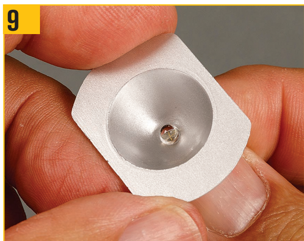
9 LEDの先端が反対側に出るようにする。
