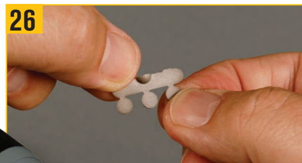
スクリューからカバープラグを取り外し、ステップ25の3つの穴のそれぞれに1つずつ押し込み、ネジ頭を隠す。
