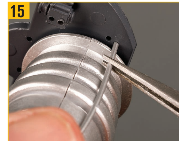
15 配管Aのもう一方の端を内部隔壁の写真の穴に取り付ける。ピンセットを使うと作業しやすい。
