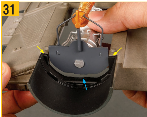
31 内部隔壁の底部にあるタブを青色の矢印の付いたスロットに合わせながら、黄色の矢印の付いたスロットに側面が収まるようにして翼ごと裏返す。
