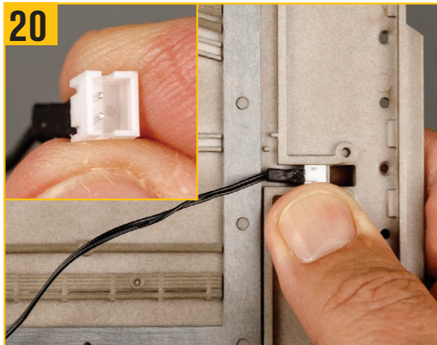
ソケットの端を確認し、ソケットをウィングチップ近くのくぼみにしっかりと取り付ける。
