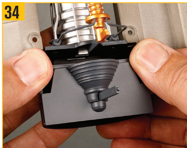
34 エンジンマウントの湾曲部分のスロットに半円形のシュラウドを押し込む。
