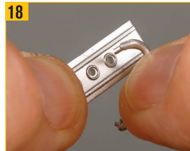
最初のマニホールド小Aをプレートのエンドホールに取り付ける。
