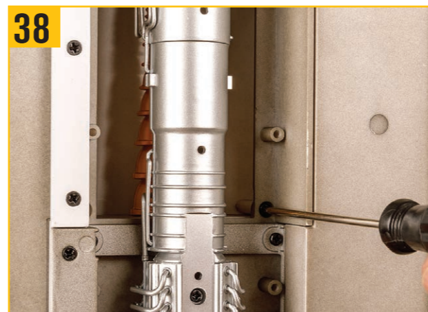
38 部品をまとめて裏返し、手順35で特定した穴にXW02ネジを押し込む。
