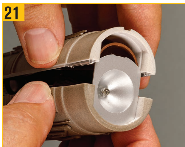
21 そして、リフレクターがエンジンケーシングのスロットに確実に収まるようにする。
