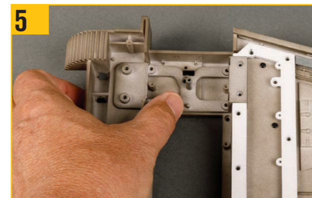
エンジンマウントの凹部に取り付け、外側の端がインナーウイングフレームの上にくるようにする。
