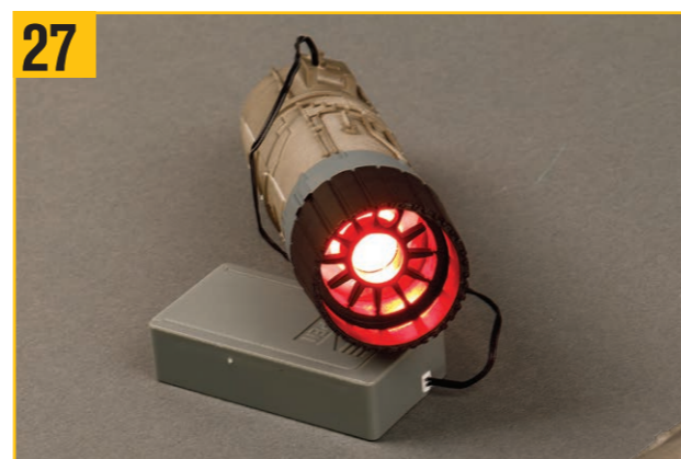
27 内部LEDが点灯し、ディフューザーが写真のように赤く光る事を確認する。
