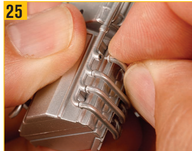
4つのパイプすべての端のピンを、マニホールド大の穴に合わせて取り付ける。
