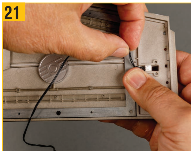
必要に応じてドライバーの先端を使用して、リード線を翼の外縁の周りに配線する。
