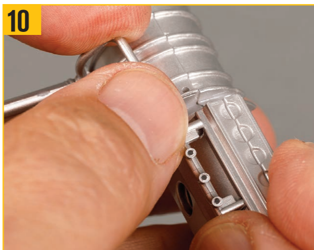
マニホールドのもう一方の端にある2つのピンを、パワー入力ユニットの上半分の穴に取り付ける。
