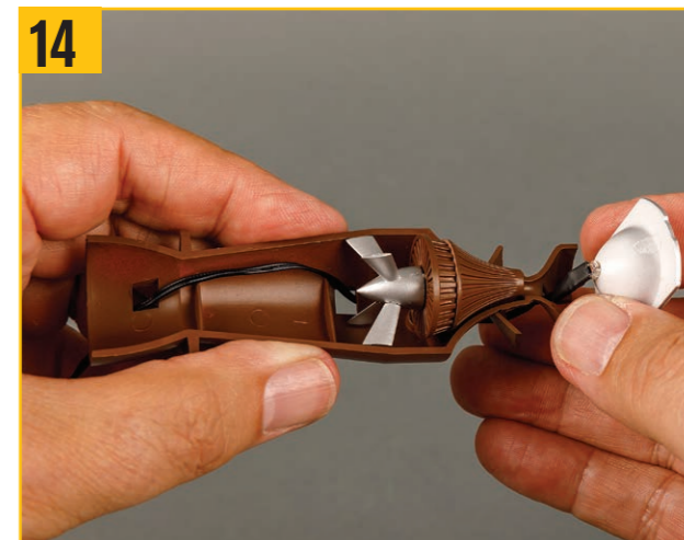
14 リフレクターがこの写真の位置にくるまでワイヤーを通す。
