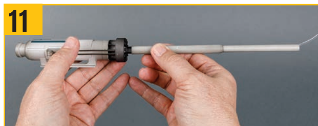
11 光ファイバーを砲身に通してから取り付け。
