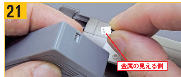
21 電池ボックスに差し込んだ、接点ベースのコンネクターをつまんで取り外し、代わりに同じ向きでレーザー・キャノン砲から出ているコンネクターを接続する。
