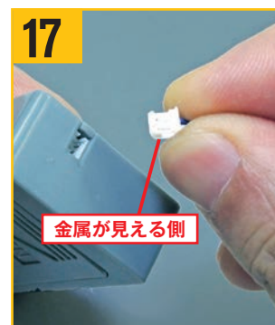
17 電池ボックスと接点ベースのコネクターを写真の向きで持つ。
