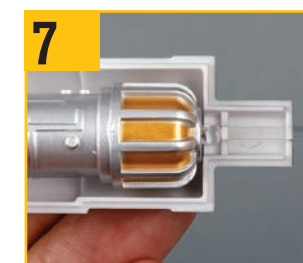
6 光ファイバーの先端を筐体(内)の溝に合わせて、レーザー発生装置のLEDに接触するように配置する。
