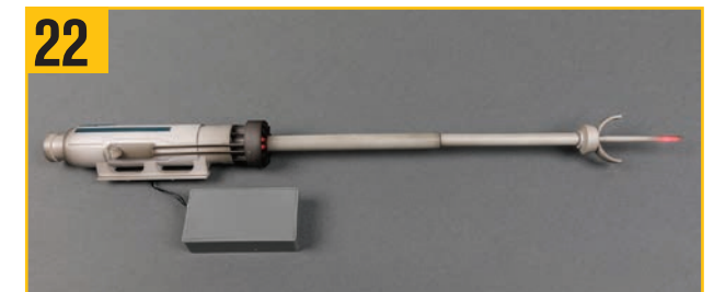
22 写真のようにLEDの点灯を確認したら、コンネクターをつまんで電池ボックスから外しておく。
