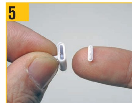
電源ユニット(前)の突起のある側を、電源ユニット(本体)の凹部分にはめ込む。
