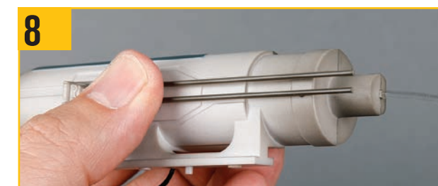
8 光ファイバーがずれないようにしながら、筐体(外)を取り付ける。
