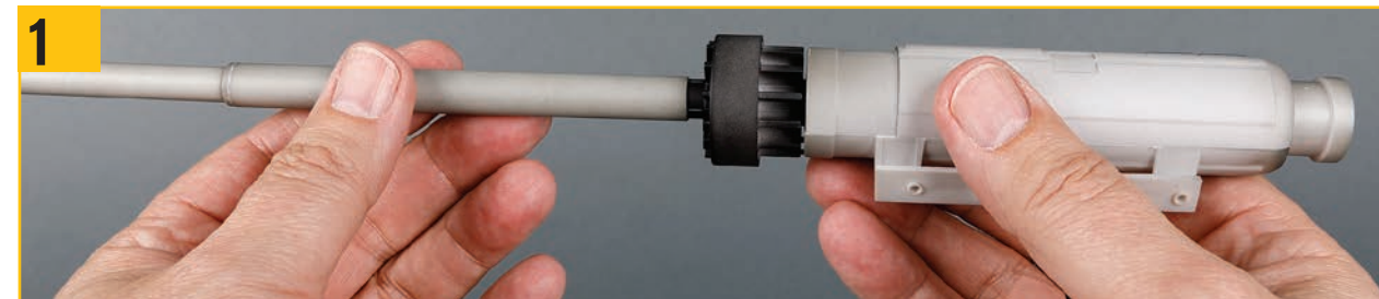
1 光ファイバーを配置するため、ステージ3で作成したレーザー・キャノン砲を分解する。
