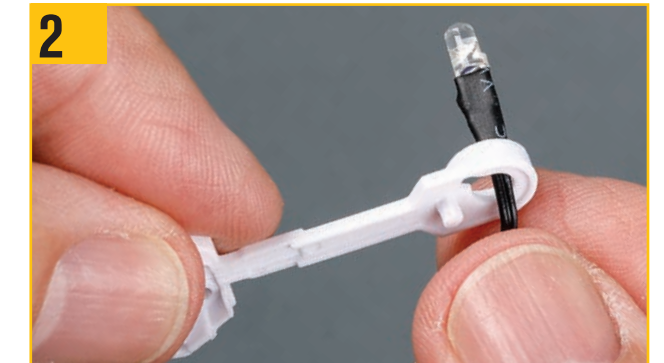
右脚(内)にある穴に、内側から接点付きLEDを写真のように通す。
