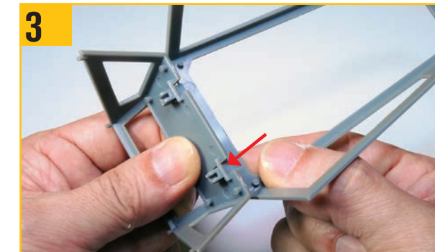
3 キャノピー後部の片方のピンにヒンジ部分を引っ掛け(赤矢印)、ピンを巻き込むようにしてキャノピーを閉じる。
