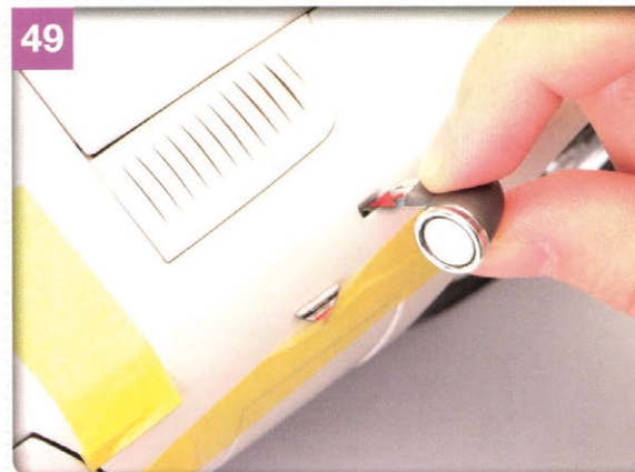
49 右フェンダーミラーを、ボディ右側面にある取り付け部に差し込む。フェンダーミラーは、外側がメッキ仕様になるよう向きを合わせる。
