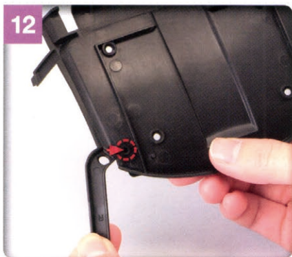
12 右Aピラークッションを用意し、写真のようにルーフクッション前縁にセットする。
