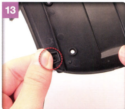
13 12と同じ要領で、ルーフクッション前縁のポストへAピラークッション端の取り付け穴をはめ込む。こちらも左と同じく仮組みとなる。
