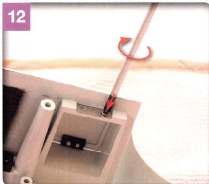
12 1番のプラスドライバーを使い、JJタイプのビスを軽くねじ込む。
