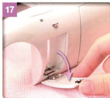
17 サービスリッドをさらに大きく開いて全開状態にする。写真のように開けばOKだ。左右とも同じように開くことを確認しておこう。
