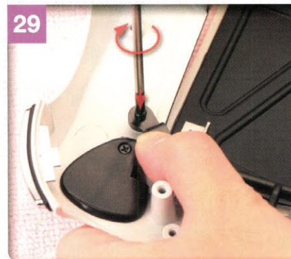
1番のプラスドライバーを使い、“左ヘッドライトヒンジが少し動く程度”にねじ込んでおく。
