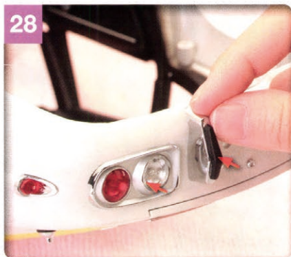
⑥右テールランプ、及び右リアバンパーも同じ要領でボディに取り付けよう。
