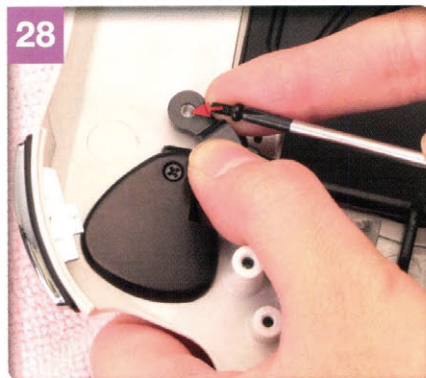
左ヘッドライトヒンジが浮き上がらないよう押さえつけたまま、Pタイプのビスを写真のビス穴にセットする。
