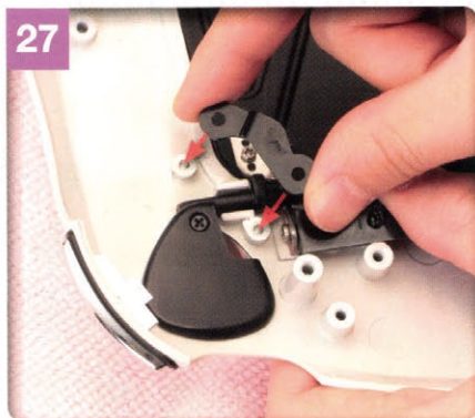
③左ヘッドライトヒンジを用意し、写真の向きで取り付け位置にセットする。
