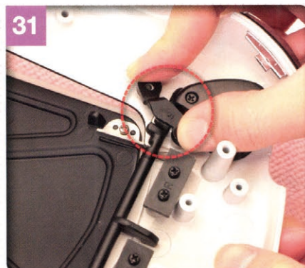
右ヘッドライトヒンジを用意し、写真の向きで取り付け位置にセットする。
