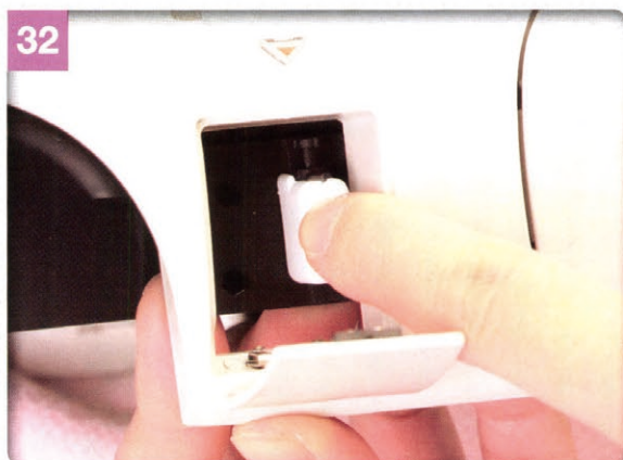
ウォッシャータンクを真っすぐに押し込み、サービスリッド内に取り付けろ。
