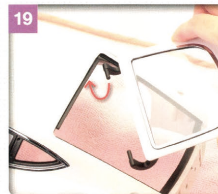
19 タオルなどを敷いた上にボディを置き、バックドアを斜めにして、先端の取り付けヒンジ部分の片側をボディにもぐり込ませる。
