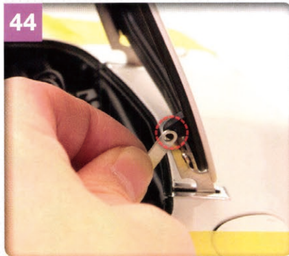
44 フードクランクを延ばし、先端の取り付け穴をフード裏面の取り付け部にセットする。
