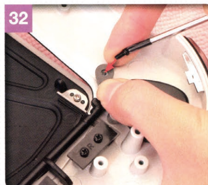
右ヘッドライトヒンジが浮き上がらないよう押さえつけたまま、Pタイプのビスを写真のビス穴にセットする。
