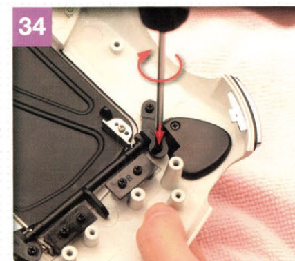
もう片方のビス穴にもPタイプのビスをセットし、32と同程度にねじ込む。
