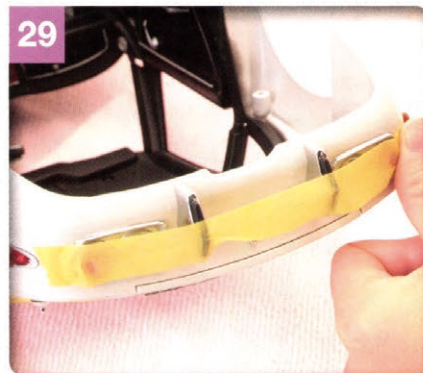
テールランプ及びリアバンパーの固定は次の作業で行うので、今回はマスキングテープを貼って仮留めしておく。
