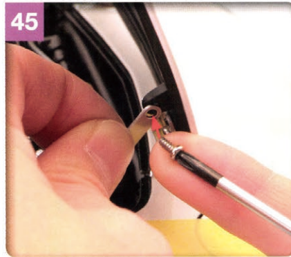
45 61号で提供したJJタイプのビスを用意し、写真で示したビス穴にセットする。
