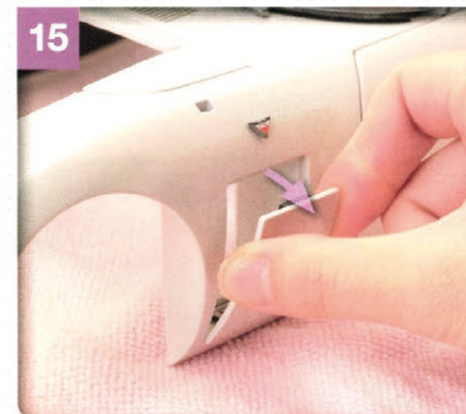
15 サービスリッドの取り付けが完了したら、開閉状態の確認を行う。まず、サービスリッドの上部を写真のように開く。
