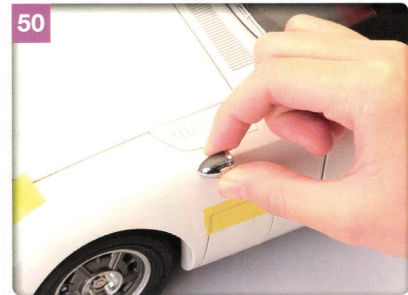
50 同じ要領で、左フェンダーミラーもボディに取り付ける。取り付けピンが長すぎて、うまく差し込めない場合は、ピンの先端部分を少しだけカットしよう。
