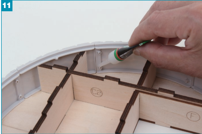
10で組み合わせた石壁の継ぎ目、突起の周囲に少量の瞬間接着剤をつけて接着します。
