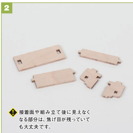
各パーツの厚みには、成型時の焦げ目があります。着色後に焦げ目が残るので、紙ヤスリをかけて取り除きます。
