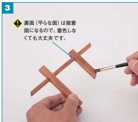
パートシェナー (こげ茶色) の絵の具を約10倍の水で溶き、2までに組み立てた梁に塗ります。
