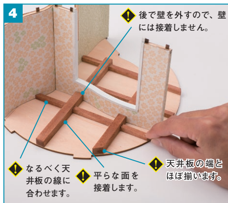
第12号で壁板を仮組みした天井板を用意し、写真の位置に梁をボンドで接着します。天井板の線になるべく合わせてください。
