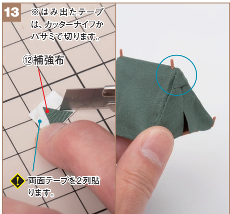
13 ※はみ出たテープは、カッターナイフかハサミで切ります。 ⑫補強布 ⚠ 両面テープを2列貼ります。
