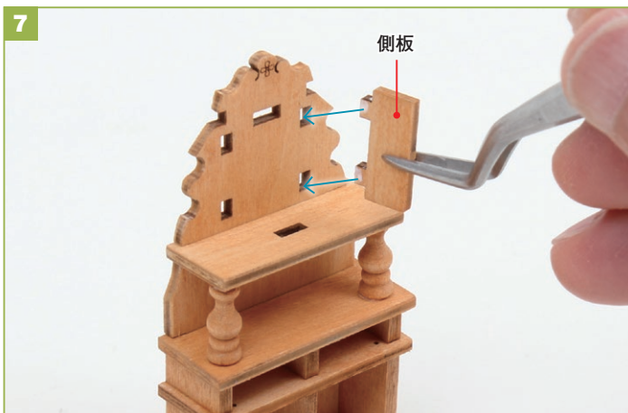
側板の突起にボンドをつけ、背板の穴に差し込みます。
