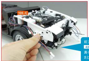
③で右側のコード類の長さを先端で揃え、前側にある2本のコードと合わせてまとめた後、105-C コードクランプより後方にある余ったコードは、タイヤより外側に出ないようボディに這わせるようにしてまとめ、ダッシュボードの内側に収めてから、2ヵ所に 107-P ステッカー(1)を貼ってください。
