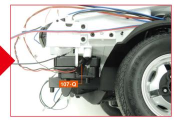
39-H リトラクタブルモーターユニットのコード(赤/黒)は、端子部分に負荷がかかると外れてしまう場合があるので、 107-Q ステッカー(2)の予備を1枚、モーターの端子部分全体にかぶせるように貼り、補強してください。
