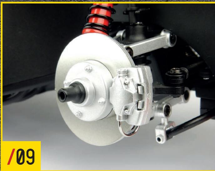
同じ手順で、フロントブレーキの右側パーツを取り付ける。
