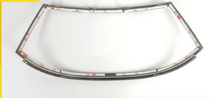
95-3(長い両面テープ)を台紙からはがし、写真のように95-1(ウィンドスクリーンフレーム)の内側に貼り付ける。
