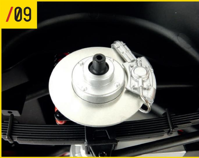
同じ手順で、リアブレーキの右側パーツを取り付ける。
