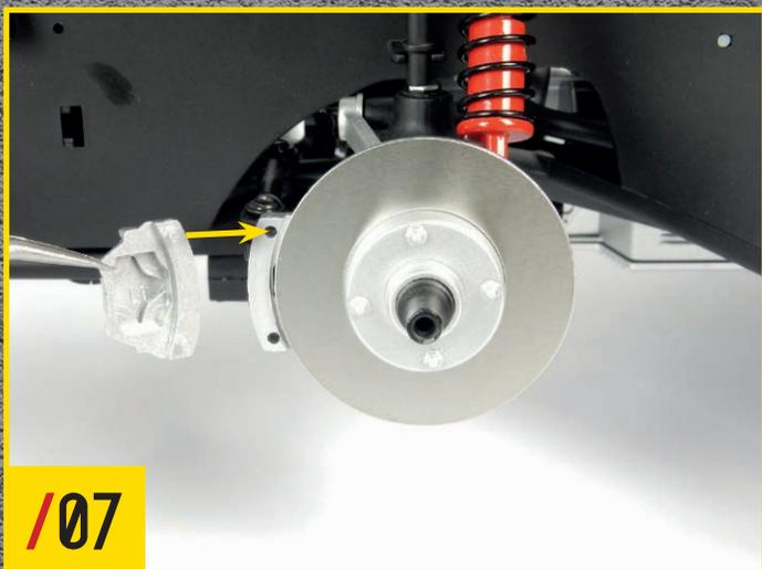
94-3(ブレーキディスク)と94-7(ブレーキキャリパー OUTERセクション)左部分(「L1」)と刻印されている)を取りつける。写真のように向きをそろえる。
