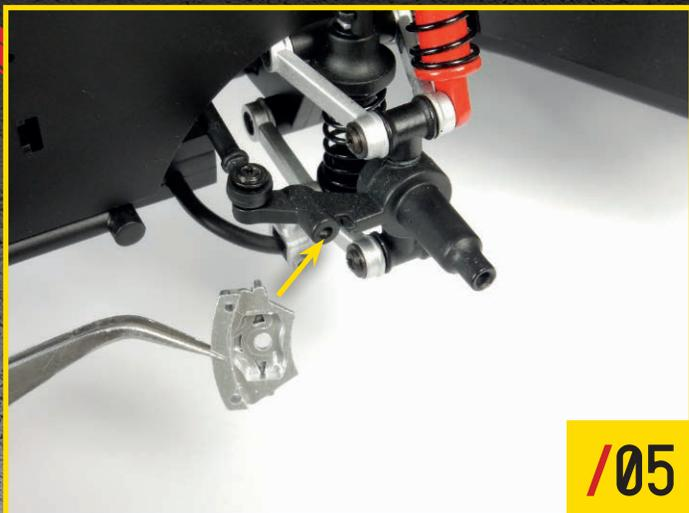
シャーシを用意する。94-6(ブレーキキャリパー インナーセクション)左部分(「L」)と刻印されている)を写真のようにリアアクスルシャフト左の位置にはめ込む。向きを確認する。
