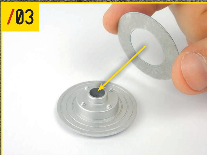
接着面を下にして、ディスクを2枚の94-3 (ブレーキディスク) に合わせる。写真のように向きを合わせよう。
