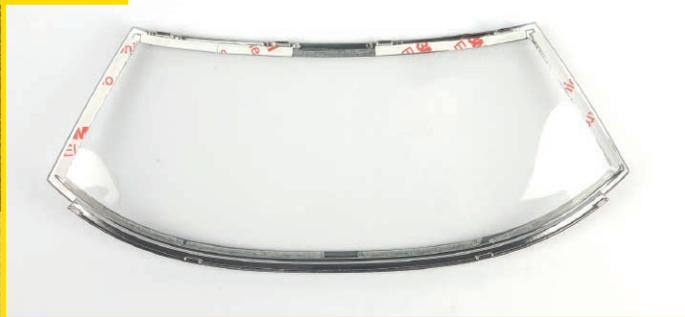
95-4(短い両面テープ)を台紙からはがし、写真のようにウィンドスクリーン内側に貼り付ける。
