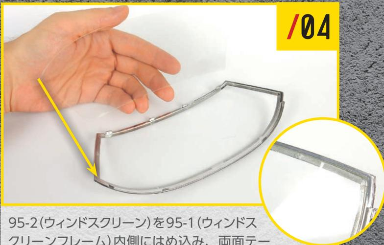
95-2(ウィンドスクリーン)を95-1(ウィンドスクリーンフレーム)内側にはめ込み、両面テープに貼り付ける。
