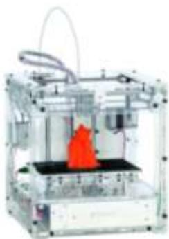
本シリーズで組み立てる 3D プリンター「idbox!」は、本体サイズ 250(W)×250(D)×270(H)ミリ、重量約 5 kg とコンパクトで軽量の 3D プリンターです。家庭にある一般的なドライバーと、シリーズで提供するレンチだけで組み立てられ、ハンダ付けは不要です。完成までは、全 55 号（約 1 年程度）で、チャレンジしやすい手軽さも大きな特徴のひとつです。
