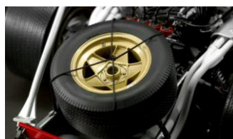
実車同様、開閉式エンジンカウル内にスペアタイヤを装備。
