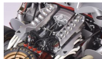
12気筒エンジンは当時のスポーツプロトタイプとして圧倒的な性能を誇る。330 P4を支えた心臓部。
