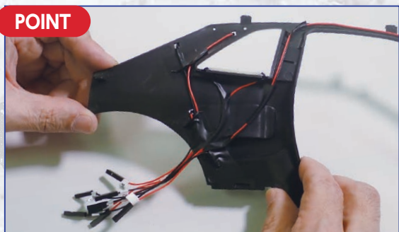
31 第69号の69.05で取り付けた右インナーパネル(66A)を外す。再びライトを点灯させて、面A(あるいは面B)が上になるように調整し、フロアパネルの裏からライトがフロアに接するまでワイヤーを引き、裏でワイヤーを絶縁テープで固定する。
