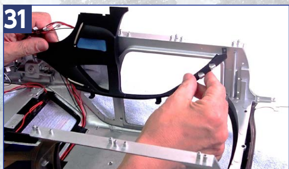
31 第69号の69.05で取り付けた右インナーパネル(66A)を外す。再びライトを点灯させて、面A(あるいは面B)が上になるように調整し、フロアパネルの裏からライトがフロアに接するまでワイヤーを引き、裏でワイヤーを絶縁テープで固定する。
