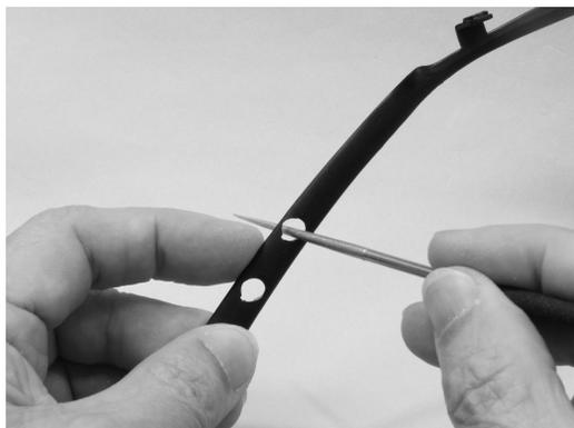
第66号 組み立てガイドのステップ66.09で、Aピラー・ブースト計(66C)およびAピラー・水温計(66D)を、右インナーパネル(66A)の穴にうまく差し込めない場合があります。穴に挿し込みにくい場合は、丸棒ヤスリなどを使って、Aピラーの穴をごく僅か広げてください。(写真参照)。
