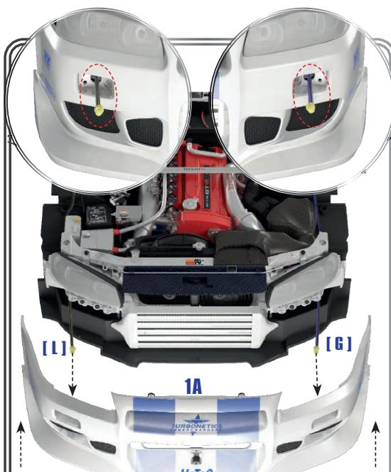
**102.14** 図をよく見て、左フロントウインカー・ワイヤー [G](47C)と右フロントウインカー・ワイヤー [L](47D)のLEDバルブを、フロントバンパー(1A)の開口部に通す。
